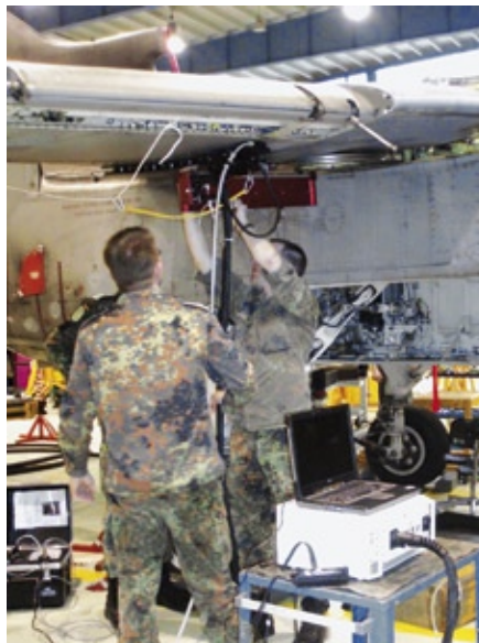
Abb. 1: Anbringen des Ultraschall-Prüfmoduls an einen Tragflügel
