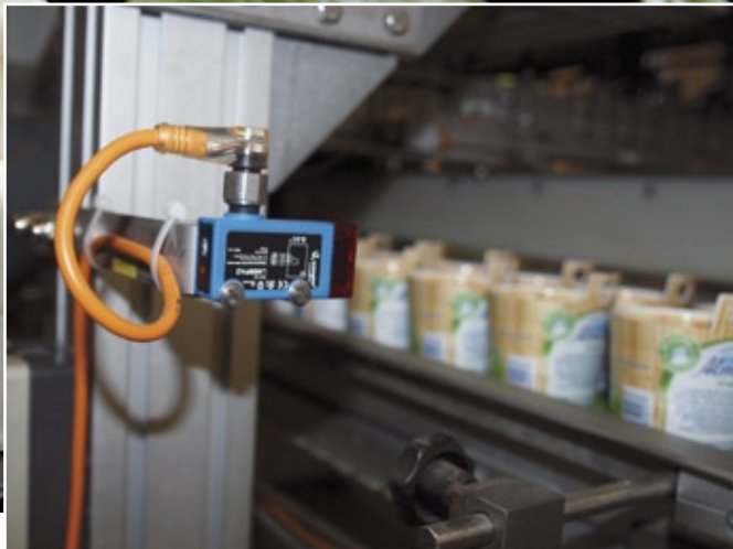
Abb. 1: Spiegelreflexschranken überwachen die Verpackung bei Hochland.
