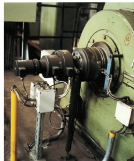
Abb. 2: Eine Kombination von Sensoren für Walzwerkantriebe: Ein digitaler Drehgeber positioniert, ein analoger Tachogenerator regelt und ein elektronischer Drehzahlschalter überwacht den Antrieb.
