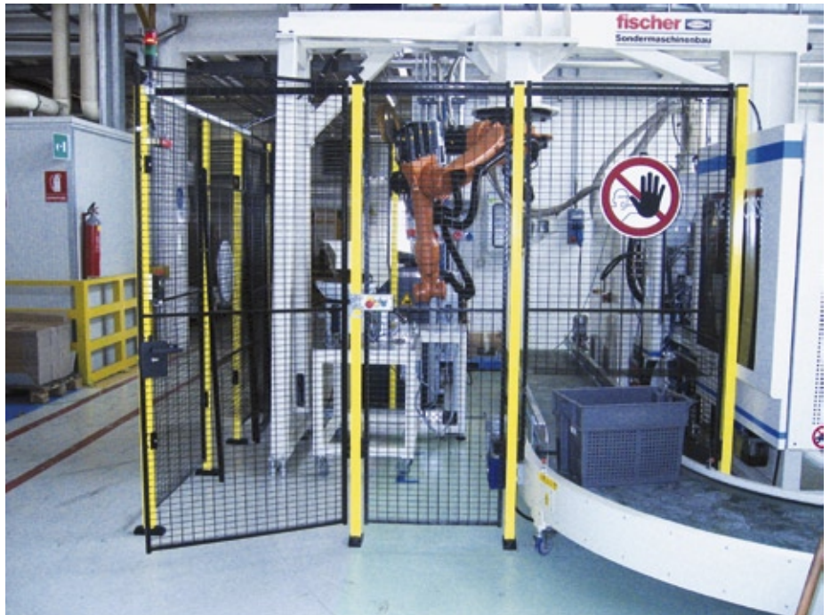
Abb. 1: Neu installiert bei der fischer-Ländergesellschaft in Italien: X-Guard entspricht bereits heute den Anforderungen an die neue Maschinenrichtlinie 2006/42/EG.
