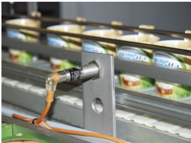
Abb. 2: Jedes Fässchen da, wo es hingehört – der Reflex-taster mit Hintergrundausbuchtung sieht alles.
