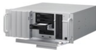
Abb. 3: Die drei Wechselplatten sind werkseitig gekennzeichnet, um das Risiko von Verwechslungen beim Austausch zu minimieren.
