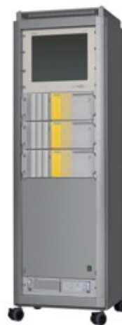
Abb. 2: Mit weniger als 450 mm Bautiefe eignet sich der Simatic IPC547C auch für den Einbau in platzsparende 500 mm-Schaltschränke.
