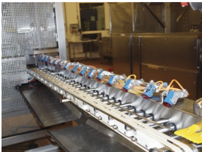
Abb. 3: Gleich kommt der Käse: Die Reflex-taster sind bereit.
