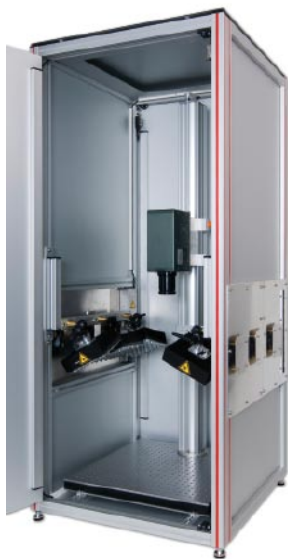
Abb. 2: Laborvariante des ThermoSpectorPV mit LED-Arrays und Infrarotkamera
