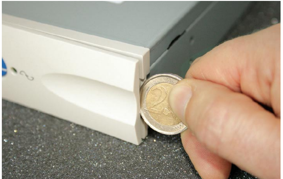
Abb. 1: Mit wenigen Handgriffen kann die Standard-Frontblende gegen die mitgelieferte schwarze Blende getauscht werden.
