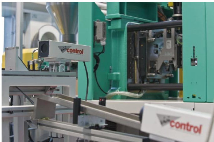
Abb. 3: Das Visicontrol BV-System integriert optional eine eigene SPS. So können Anwender zahlreiche I/O-Funktionen wie das Ausschleusen von Schlechtteilen ohne zusätzliche Schnittstellen realisieren und zudem mittels der visicontrol-eigenen BV-Software visiTeach direkt in das telespezifische BV-Programm komfortabel einbinden. Nach der Entnahme der Einzelteile aus der Maschine kontrolliert und protokolliert das visicontrol Bildverarbeitungssystem jeden Montageschritt, so dass nur fertig montierte IO-Teile in der „Gut-Kiste“ landen.
