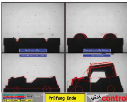
Abb. 4: Neben geometrischen Qualitätsmerkmalen kann die Bildverarbeitung auch attributive Merkmale wie etwa Farbschlieren auswerten.
