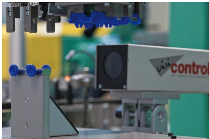
Abb. 3: Das Visicontrol BV-System integriert optional eine eigene SPS. So können Anwender zahlreiche I/O-Funktionen wie das Ausschleusen von Schlechtteilen ohne zusätzliche Schnittstellen realisieren und zudem mittels der visicontrol-eigenen BV-Software visiTeach direkt in das telespezifische BV-Programm komfortabel einbinden. Nach der Entnahme der Einzelteile aus der Maschine kontrolliert und protokolliert das visicontrol Bildverarbeitungssystem jeden Montageschritt, so dass nur fertig montierte IO-Teile in der „Gut-Kiste“ landen.
