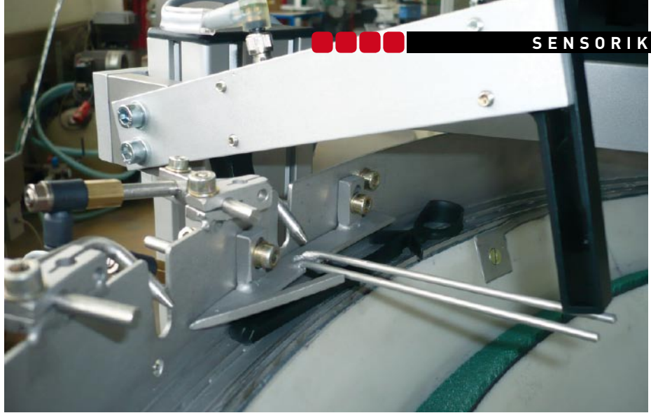
Abb. 2: Die Gabellichtschranken des Typs GL121-IR eignen sich zur Gut/Schlechterkennung und der Lage der Kunststoffriegel im Wendelförderer.
