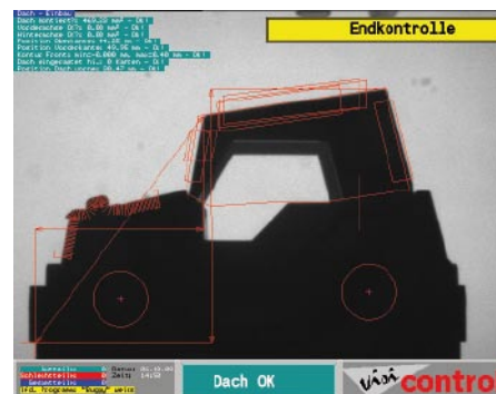
Abb. 1: Bildverarbeitung arbeitet berührungslos und lässt sich für viele Merkmale sowie Varianten flexibel und schnell programmieren und auf neue Prüfaufgaben umstellen.
