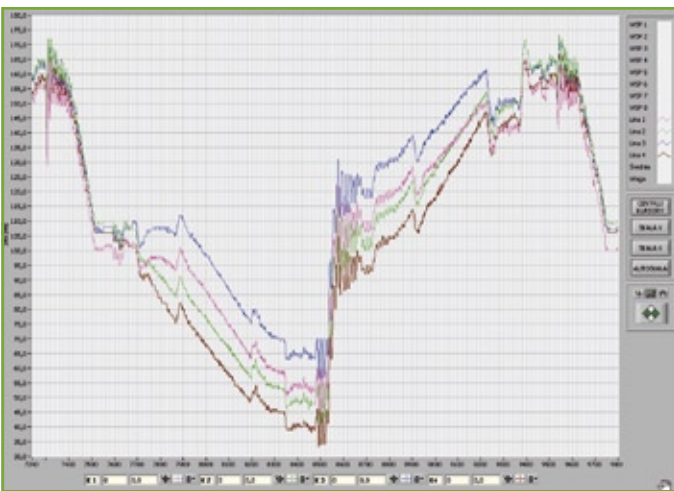
Abb. 4: Diagramm der in den Seilen eines Fördergefäßes wirkenden Kräfte nach der dritten korrigierenden Maßnahme
