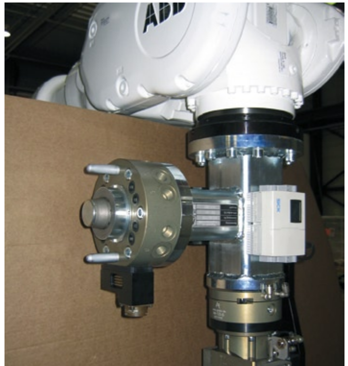
Abb. 8: Die sich aus der \mu -genauen Vermessung der Kantenlage durch den OD MAX ergebenden Positionsdaten des Moduls werden von der Robotersteuerung zur Führung der Schneidwerkzeuge genutzt, so dass ein exakter Beschnitt der überstehenden Folienreste direkt an der Glaskante des Moduls sichergestellt ist.
