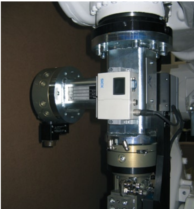
Abb. 7: Die Erfassung der Kantenlage vor dem Edgetrimming – dem Abschneiden der über die Modulkante stehenden Folienreste – erfolgt auf wenige \mu genau mit Hilfe eines Displacementsensor OD MAX.
