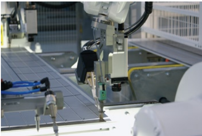
Abb. 5: Erst der Einsatz der IVC-2D ermöglicht es den Robotern die Folien und Lötbander genau abzulegen und die Lötunkte sehr exakt zu positionieren.
