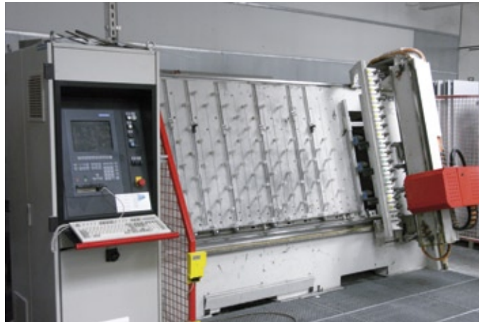
Abb. 4: Zum Bohren der Montageplatten und zur Herstellung der Ausschnitte steht ein CNC-Bearbeitungszentrum von Perforex zur Verfügung, ...
