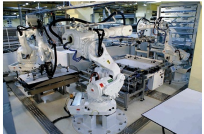
Abb. 6: Beim Querverschaltung von einzelnen Strings zu einer Matrix – dem eigentlichen Photovoltaikmodul – kommen pro Linie je vier Roboter vom Typ IRB 1600 zum Einsatz.
