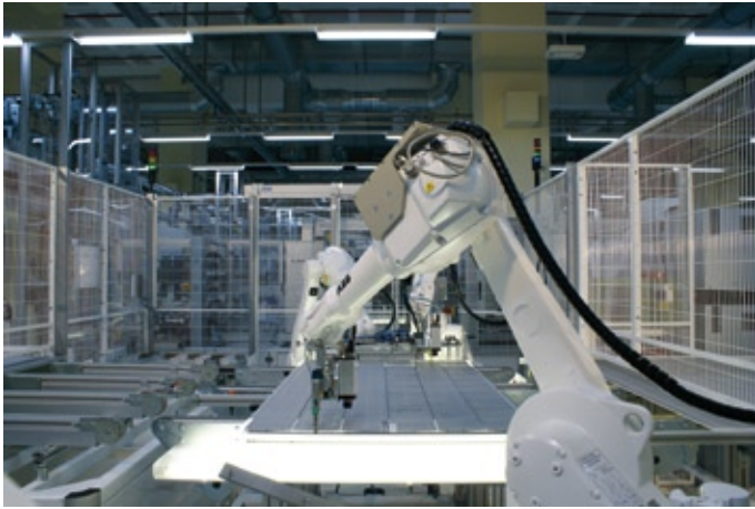
Abb. 3: Die Roboter IRB 1600, die je einen Lötkopf führen, sind mit einer Smartkamera IVC-2D ausgerüstet.
