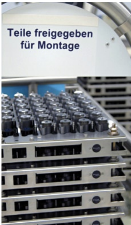
Abb. 1: Die BIS-C Datenträger an den Werkstückträgerpaletten beinhalten chargenbezogene Fertigungsdaten, die von Station zu Station aktualisiert werden.
