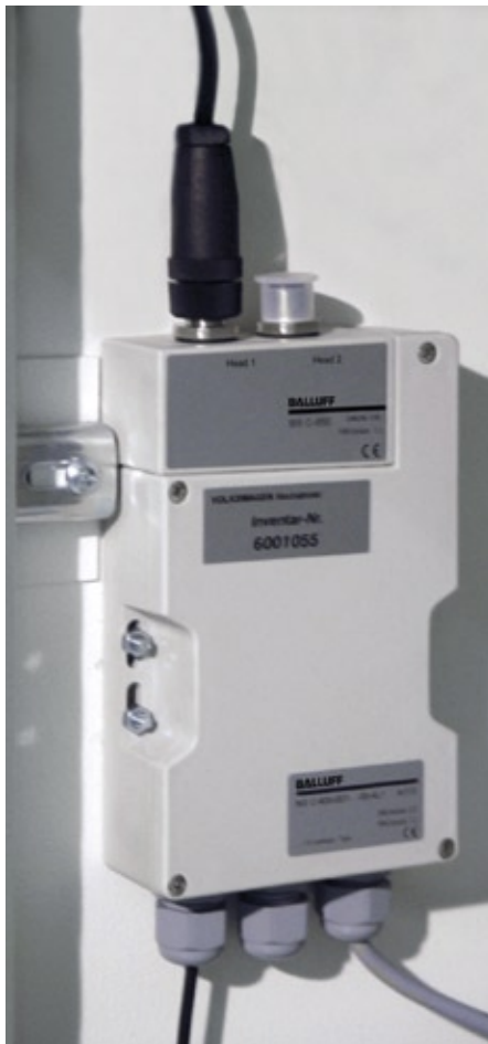
Abb. 3: Die Auswerteeinheit den Datentransfer zwischen Datenträger und dem steuernden PC am CAQ-Arbeitsplatz.
