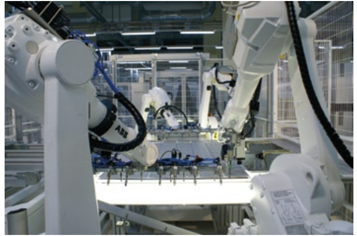
Abb. 4: Mit Hilfe der IVC-2D werden an der Modulober- und -unterseite die Lage und Position der Zellen und Lötbandchen ermittelt.
