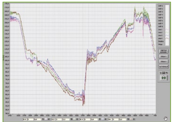
Abb. 5: Diagramm der in den Seilen eines Fördergefäßes wirkenden Kräfte nach der Korrektur (vom Benutzer als zufriedenstellendes Ergebnis anerkannt).
