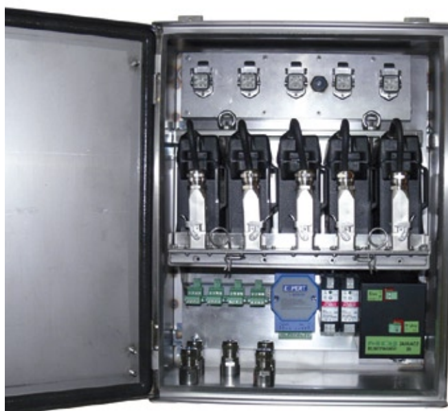
Abb. 1: Anschlussverteiler mit Mikroprozessorsteuerung (Akku gepuffert) zur Messung der Belastungen der Oberseile eines Schachtfördergefäßes mit Steckverbinder Han Q5/0 Quick Lock im Gehäuse Han 3A Inox. Ausgleich der Belastungen der Oberseile eines Schachtfördergefäßes
