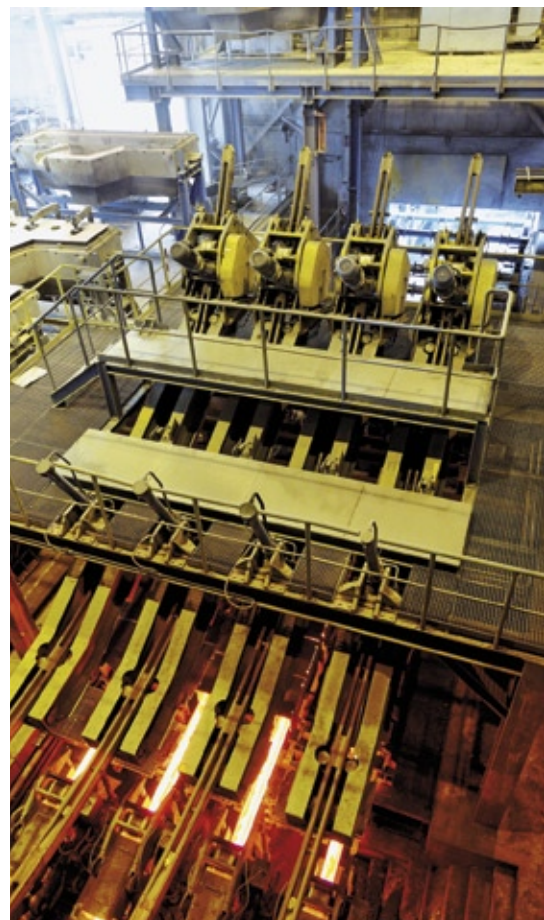
Abb. 2: Das flüssige Material fließt in die Barrenform der Stranggussmaschine ein (vorne) und verlässt diese hinten als noch heiße Stahlknüppel. Um ein Festkleben des flüssigen Stahls an den Gussformen (Kokillen) zu vermeiden, hält ein Simovert Masterdrives Umrichter diese konstant in Bewegung.
