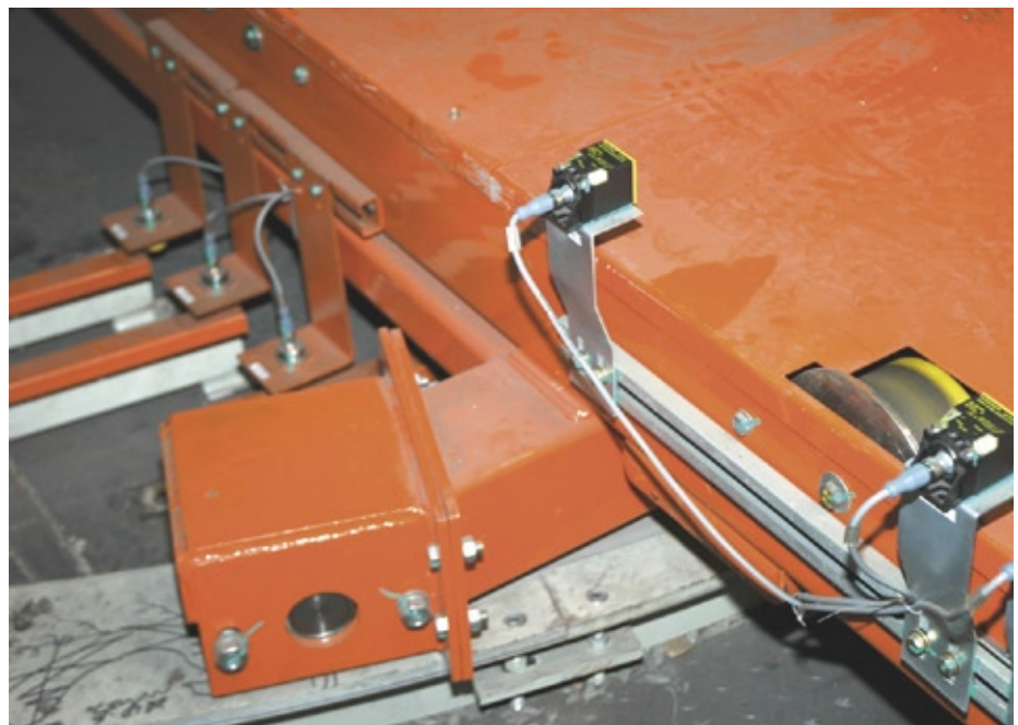
Abb. 3: Alles im Blick: Bei FAW-VW erfassen die zahlreichen Turck Ni50U-CK40-Sensoren alle Metalle mit erhöhten Schaltabständen bis zu 50 mm
