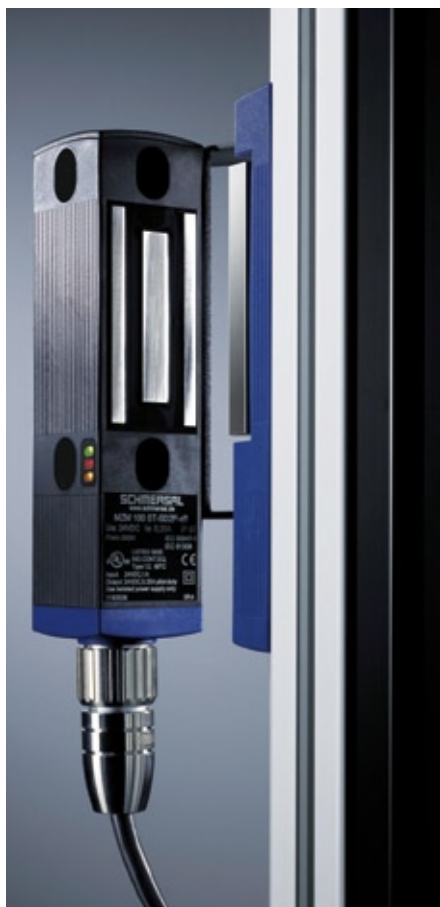
Abb. 2: Berührungslos zuhalten: Mit der Sicherheitszuhaltnung MZM 100 ist das kein Widerspruch. Ein Elektromagnet erzeugt eine Zuhaltkraft von 500 N.
