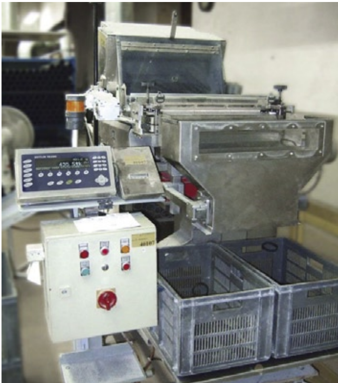
Abb. 2: Das übersichtliche Terminal zeigt den Stückwert an. Ein zusätzliches visuelles Signal informiert die Mitarbeiter, wenn die Sollmenge erreicht ist.
