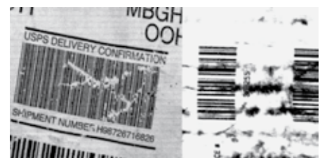
Abb. 4: Kamera-basierte Identifikationstechnologie liest selbst verschmutzte oder teilweise zerstörte Barcodes.
