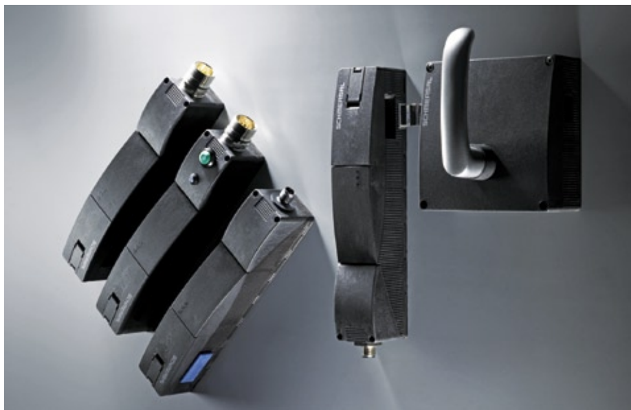
Abb. 1: Zwei statt einer: Mit einer Sicherheitszuhaltnung vom Typ AZM 200 kann man eine Schutztürüberwachung nach Steuerungskategorie 4 [EN 954-1] bzw. Performance Level „e“ gemäß EN 13849 realisieren – ohne zusätzlichen Schalter für die Türüberwachung.
