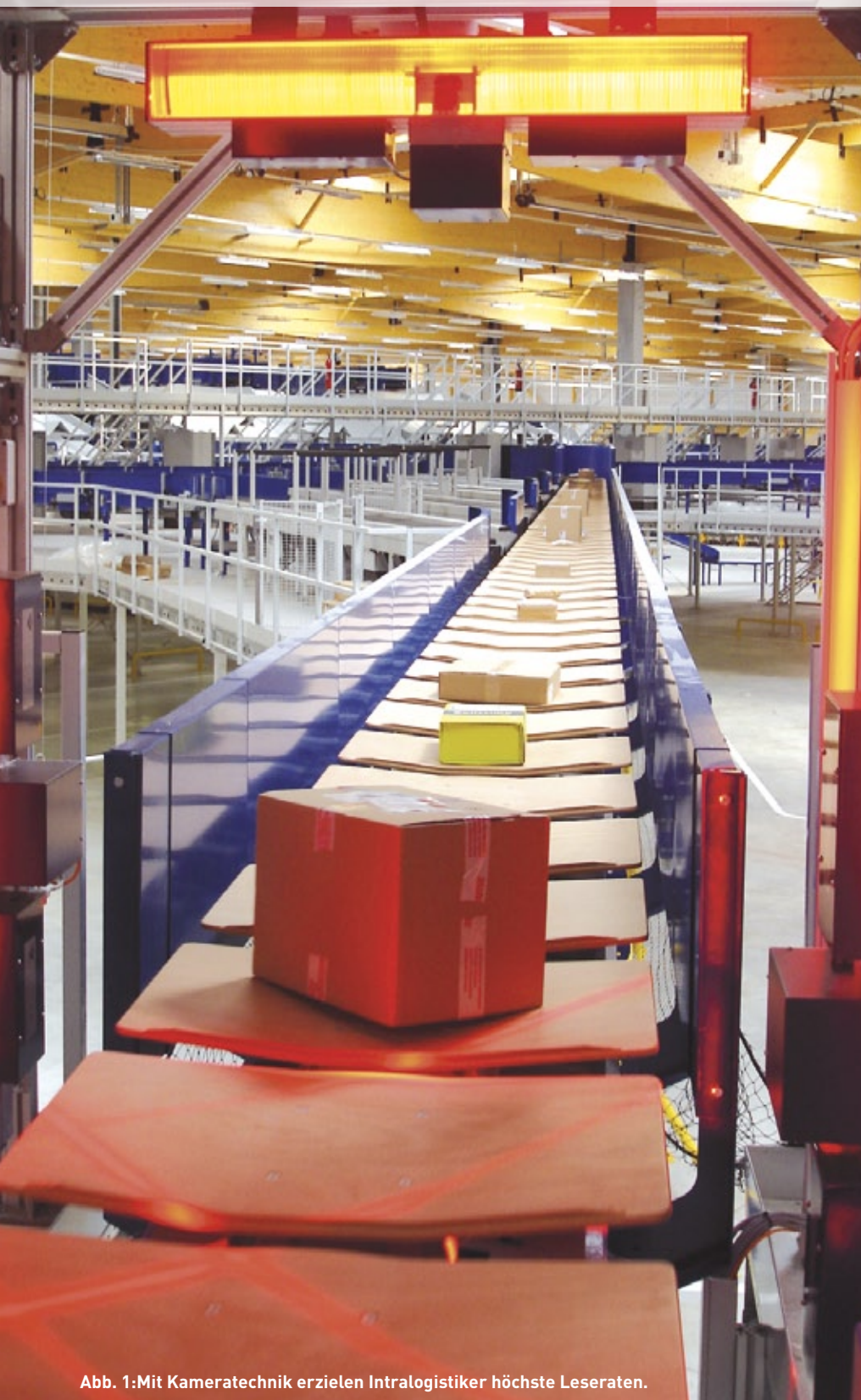
Abb. 2: Ein Laserscanner scannt bei einer Fördergeschwindigkeit von 2m/s mit einer Abtastrate von 8 Scans pro 10 mm.
