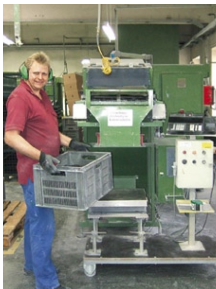
Abb. 1: Wenn die Sollstückzahl erreicht ist, schaltet das Wägeterminal den Materialfluss ab. Nun kann der Behälter gewechselt werden.
