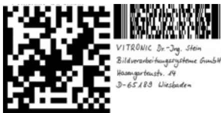
Abb. 6: Zusätzlich zur Barcodelesung können mit Kameras 2D-Codes und Klarschrift gelesen werden.
