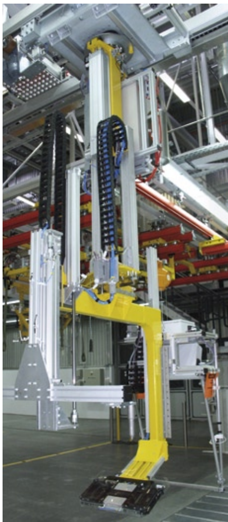
Abb. 2: Die Kabelschlepp-Energieführungssysteme Mono, Uniflex und Robotrax an Innotech-Handhabungsgeräten
