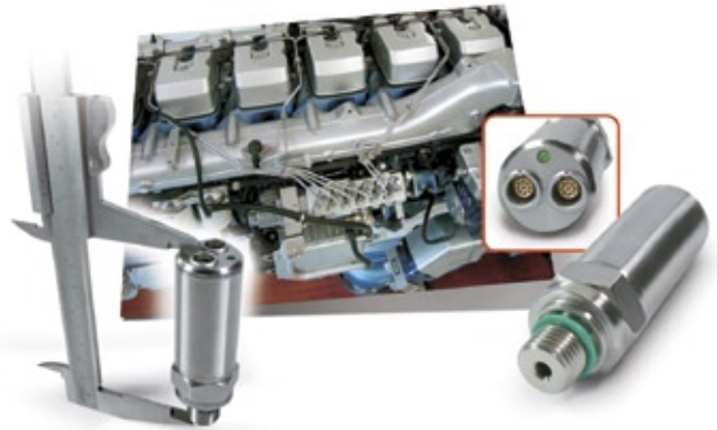
Abb. 4: Druckmessstellen direkt im Motorraum können einfach in die Messkette eingebunden werden. (Foto: Ipetronik)
