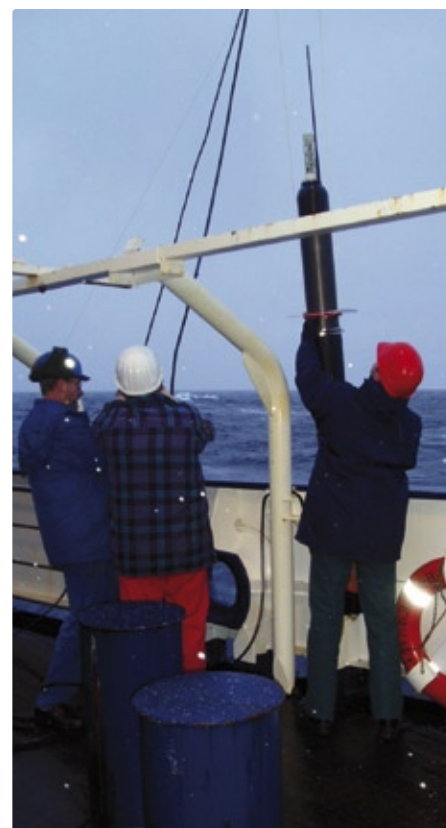
Aussetzen des ersten Nemo-Floats mit einer maximalen Tauchtiefe von 1.000 m. Salzgehalt, die Temperatur und der Druck werden aufgezeichnet. (Foto: Optimare Sensorsysteme AG)
