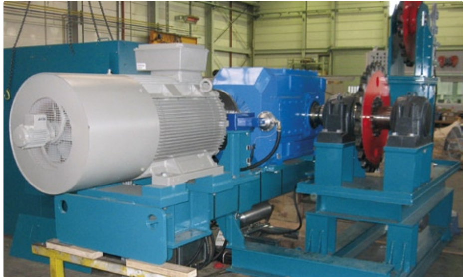
Antriebsstation mit 300-kW-Asynchronmotor. Der am Wellenende angebrachte inkrementale Drehgeber gewährleistet hohe Präzision und höchste Zuverlässigkeit für den vertikalen Kettenlift.
