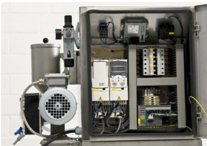
Hansa Industrie-Mixer setzt beim neuen Labor-Mixer auf eine SPS und auf Frequenzumrichter von ABB.
