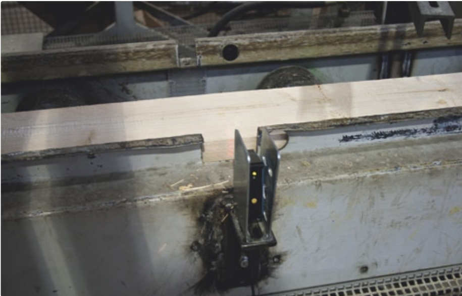
Der Reflex-Array-Sensor mit 50 mm hohem Lichtband ersetzt mehrere Lichtschranken mit punktförmigem Lichtstrahl und reduziert dadurch die Anzahl der Sensoren.
