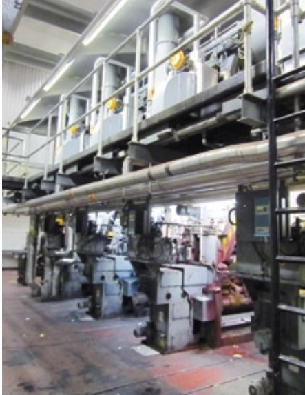
Die Tiefdruckmaschine mit acht Druckwerken, die auf AKD-Drives und AKM-Motoren von Kollmorgen umgestellt wurde, ist jetzt leistungsfähiger.
