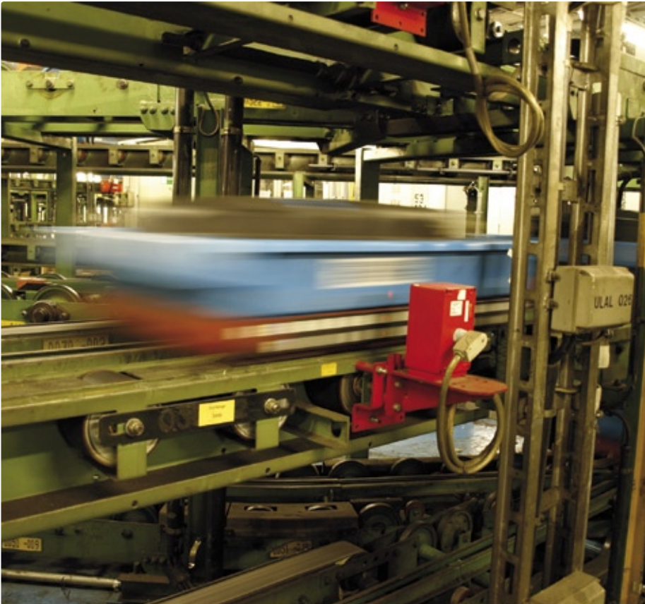
Trotz Geschwindigkeiten bis 10 m/s erkennen die Sensoren die Behälter fehlersicher.
