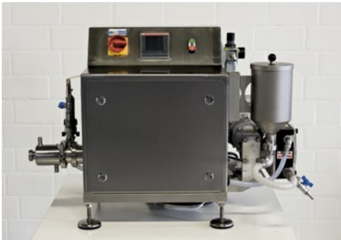
Der Mixer Pico-Mix unterstützt Laboratorien bei der Entwicklung von Schaumprodukten.
