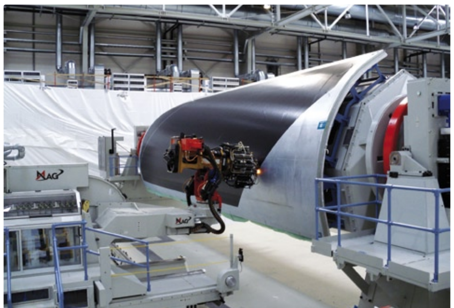
Die Produktion des Airbus A350 bei dem Zulieferer Premium Aerotech beginnt: Erstes Legen der CFK-Fasern auf die Legeform für die Oberschale der Sektion 13/14 der A350 in Nordenham. (Foto: Premium Aerotech GmbH)
