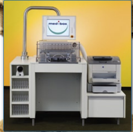
Halbautomatischer Blisterautomat für bis zu 500 Packungen pro Woche. (Foto: Med-i-tec GmbH)
