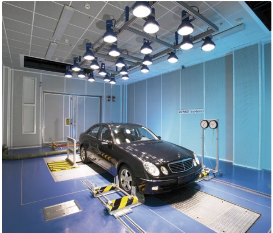
In der schallgedämpften Geräuschkammer werden bei Denso in Eching Geräuschmessungen nicht nur an den eigenen Produkten, sondern auch an den gesamten Fahrzeugen vorgenommen.
