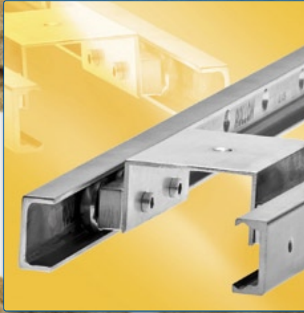
Die Festlager/Loslager-Kombination aus T- und U-Profil gleicht Parallelitätsfehler aus.
