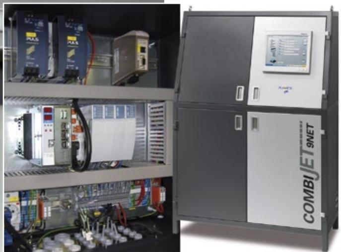
**Abb. 1:** Durch Einsatz des Varan-Bus reicht eine einzige CPU aus, um alle Steuerungs- und Visualisierungsaufgaben bis hin zur Verbrauchsmittelüberwachung zu übernehmen.
