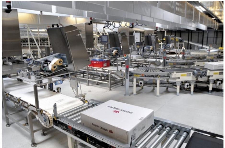
Die gesamte Produktion, von der Herstellung bis zur Verpackung, basiert auf einer kompletten Profinet-Lösung mit Safety.
