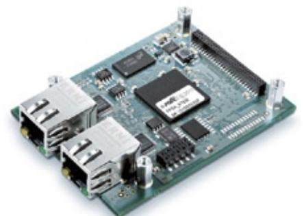
**Abb. 2: Real-Time Ethernet-Module 201005**
