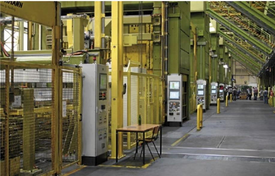
Nach der Modernisierung der Automatisierung von Pressen und Feedern ist der Ausstoß der hoch flexibel einsetzbaren Pressenlinie 1 von Hörmann Automotive Components um 50 % höher (gemessen an einem Referenzteil).
