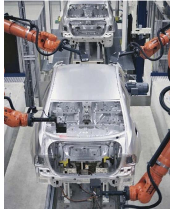
**Die Funktion ‚Fast-Start-up‘ ermöglicht nach einem Werkzeugwechsel an Robotern den schnellen Hochlauf von Geräten, so dass die geforderten Anlagentakt- und Prozesszeiten der Produktion eingehalten werden können.**
