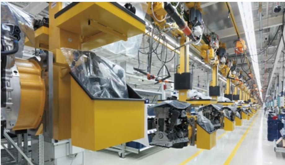
Abb. 1: Auf drei Linien wird bei der MDC Power GmbH im thüringischen Kölldeda der „Welt-Dieselmotor“ OM651 montiert, und an die Daimler-Werke weltweit ausgeliefert.
