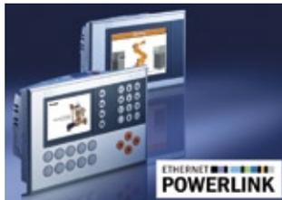
Antriebe über modulare Feldbuschnittstellen auf einfache Weise anbinden. So ist das PP65 wahlweise mit integrierter X2X oder Powerlink-Schnittstelle erhältlich.
