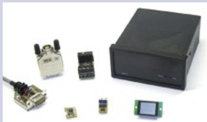
eignet. Mit diesem System lassen sich Sensoren in Aufnehmer mit Messverstärkerfunktion umwandeln. Der DMS-Messverstärker MDU eignet sich zum Betrieb von  $\pm 2$  mV/V DMS-Vollbrücken. Das Ausgangssignal beträgt dabei 0,5 ... 4,5 V ( $2,5 \pm 2$  V).
