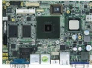
pactFlash™ Sockel und Digital I/Os. Der Arbeitsspeicher kann mit einem bis zu 2GB DDR2 SO-DIMM erweitert werden.
