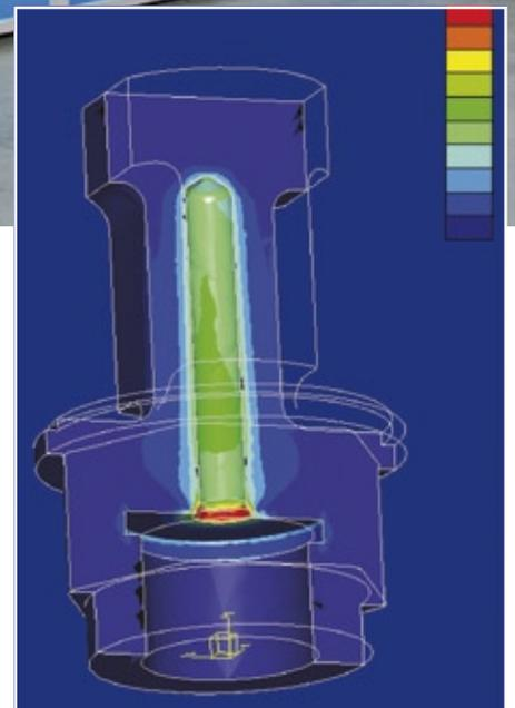
**Abb. 3: FEM-Simulation der Vergleichsspannungen**
