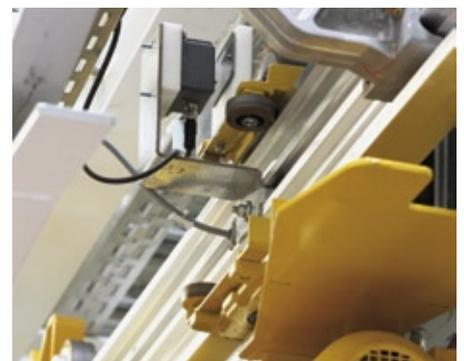
Abb. 2: Für transparenten Materialfluss sorgt auch das RFID-System Simatic RF300 mit Lese / Schreibgeräten an wichtigen Stellen der Einschienenhängebahn-Strecken und batterie-losen Transpondern an den Laufwageneinheiten.
