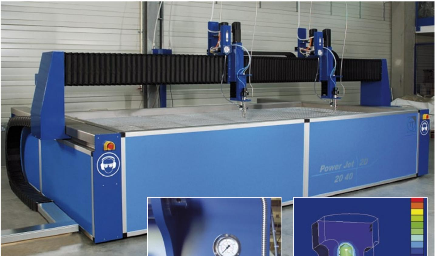
**Abb. 1: Wasserstrahlschneideanlage vom Typ Power Jet (Quelle: TrennTek)**
