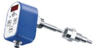
Für präzise Messungen und schnelle Ansprechzeiten hat *Danfoss* ([www.danfoss.com/ia](http://www.danfoss.com/ia)) den **Temperaturfühler** MBT 3270 entwickelt, der sich für den Einsatz in Abgas-Rückführungs-Systemen in Verbrennungsmotoren eignet. Bei Lastwechsel muss sich das System schnell auf die neuen Anforderungen einstellen können. Dies erfordert eine sehr schnelle Reaktionszeit der Temperatursensoren bei Abgastemperaturen bis zu 300 °C.
