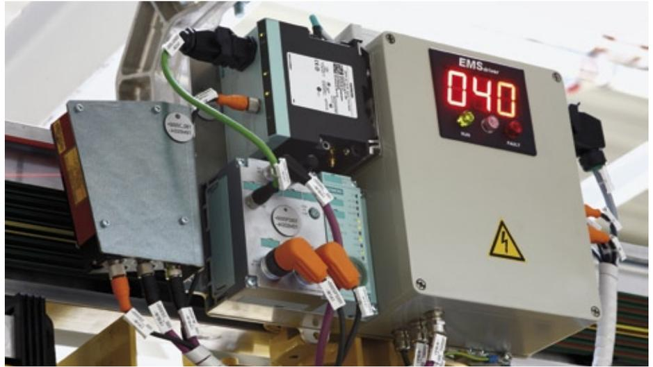
**Abb. 3: Kompakte und robuste Automatisierungslösung direkt an den Laufwageneinheiten: Steuerung, Antrieb und Kommunikation schaltschranklos auf engstem Raum vereint ermöglichen Zeit sparende Installationen im Feld.**
