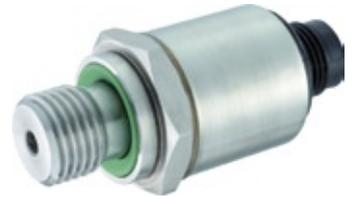
Der Midas C08 stellt das Basisprodukt der **OEM-Druckmessumformerserie** von *Jumo* ([www.jumo.net](http://www.jumo.net)) dar. Die hohe Schwingfestigkeit sorgt für eine langjährige Einsatzbereitschaft. Der Temperaturkompensationsbereich liegt bei -20...+100 °C und gewährleistet eine Messgenauigkeit im Einsatztemperaturbereich von -30...+125 °C. Geeignet ist dieser Druckmessumformer für Relativdruckmessungen im Bereich von 0...1,6 bar bis 0...60 bar.
