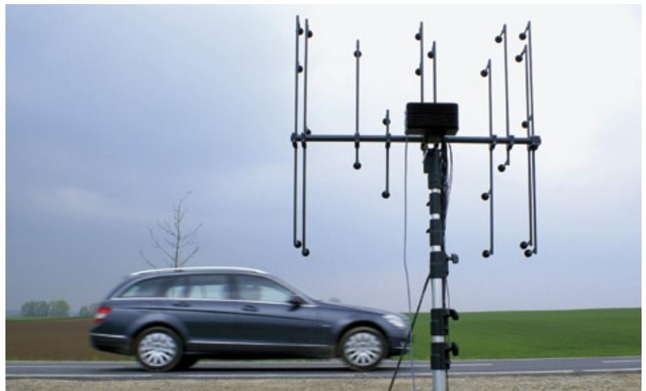
Auch bei Vorbeifahrtmessungen, vor allem bei dichtem Verkehr, kommt das Schallanalysetool zum Einsatz
