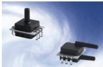
Der MS5607 von *Amsys* ([www.amsys.de](http://www.amsys.de)) ist ein **ultra-miniaturisierter Drucksensor** (5x3x1,6 mm<sup>3</sup>) mit einer Auflösung von 24 Bit. Auf der Grundlage jahrelanger Erfahrung wurde die Silizium-Messzelle stark verkleinert und für das Signalauswerte-ASIC ein CMOS-Prozessor benutzt.
