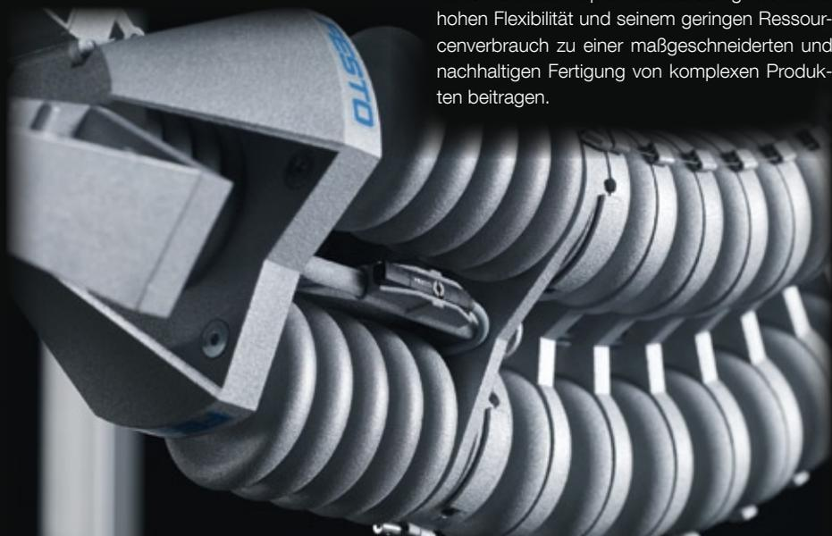
**Die Struktur des mechanischen Rüssels, bestehend aus drei Grundelementen zur Bewegung im Raum, Handachse und Greifer**
