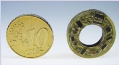
12 Bit Auflösung. Aufgrund des geringen Gewichts von 2 g ist die Rückwirkung auf den Ventiltrieb vernachlässigbar. Kennzeichnend ist, dass kein kontinuierlicher Signalkontakt erforderlich ist.
