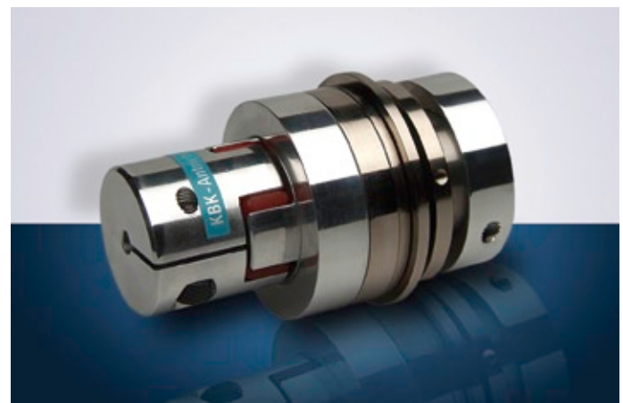
Der Elastomerstern der Serie KBK/EK kompensiert Stöße und Vibrationen und wirkt elektrisch isolierend.
