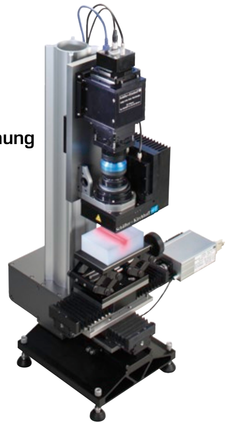
Abb. 1: Der gesamte Aufbau des Scan-Makroskops.
