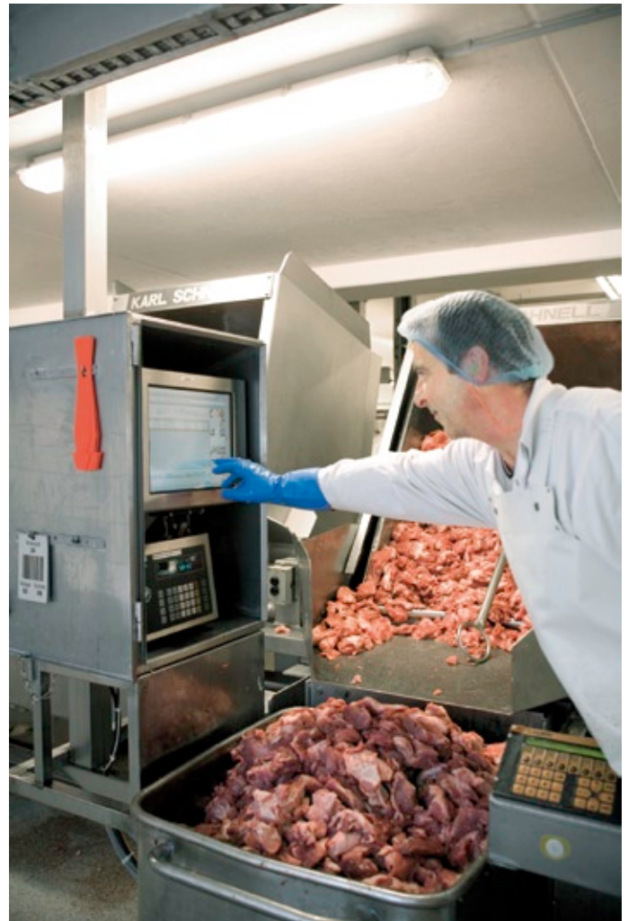
Damit es schmeckt: Der Noax-IPC an der Rezepturverwiegung kontrolliert die Zusammensetzung der einzelnen Wurstkomponenten.
