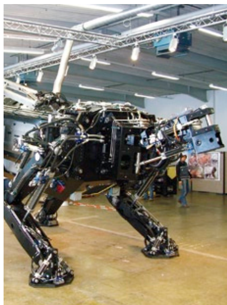
Das Stahlgerüst des Roboters mit 50 hydraulischen, 10 pneumatischen und 12 elektrischen Antrieben
