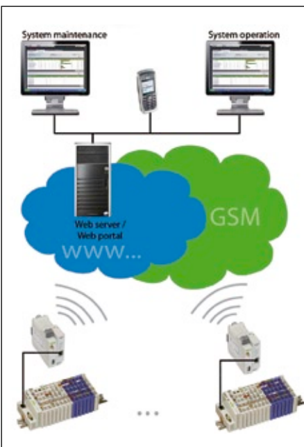
Abb. 2: Fernwirklösung für E-Plus: Gesamtüberblick
