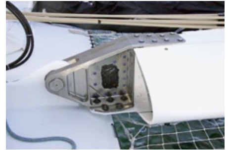
Über 40 Vollbrücken wurden von HBM Servicetechnikern installiert und mit entsprechenden Materialien vor äußeren Einflüssen geschützt.
