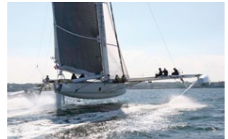
Hydroptère, das schnellste Segelboot der Welt, beginnt ab einer Geschwindigkeit von 15 Knoten zu fliegen.
