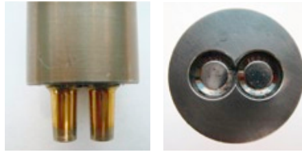
Herstellung einer Tox-Twinpoint-Verbindung mit Stempel und Matrize
