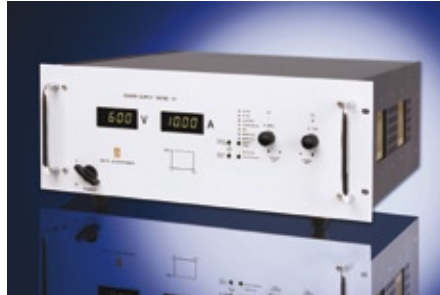
Das Netzteil SM 600-10 aus dem Hause Delta Elektronik ist die Energiezentrale der Konfiguration
