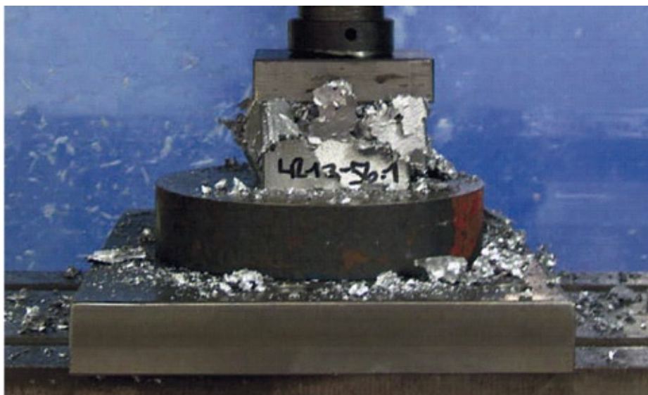
Bei der statischen Stauchung der Aluminium Crash-Boxen arbeitet die i-Speed im Zeitraffermodus.
