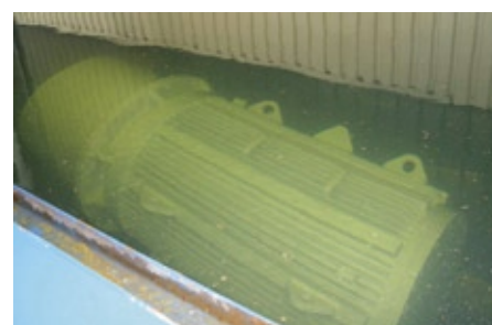
Ein Motor für Unterwassereinsatz wird im Wasserbecken typ-getestet
