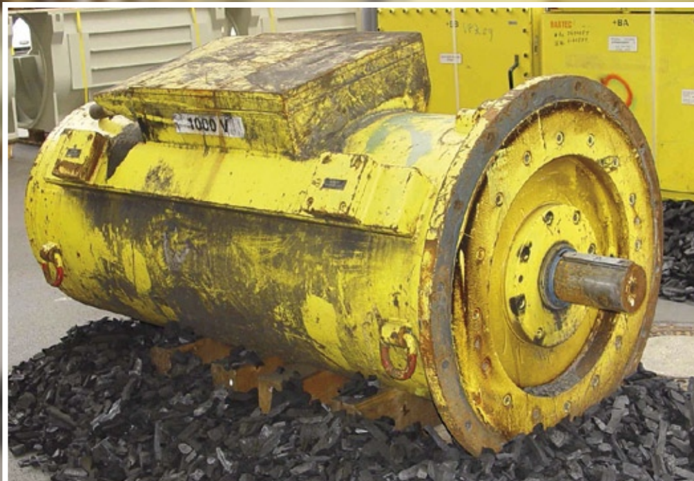
Staub führt im Kohle-Bergbau zu erhöhtem Explosionsrisiko: Ein Ex-Motor der Zündschutzart Ex D I, Baugröße 315, 500 KW mit Wasserkühlung für Bandantriebe wird eingesetzt
