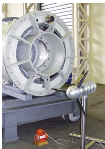
Der Generator für die Gezeitenströmungsturbine (Hintergrund) sowie als maßstäbliches Modell
