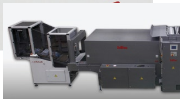
Abb. 1: Eine Schrumpffolie fixiert die Versandprodukte auf einen Trägerkarton (Foto: Kraus Maschinenbau GmbH)
