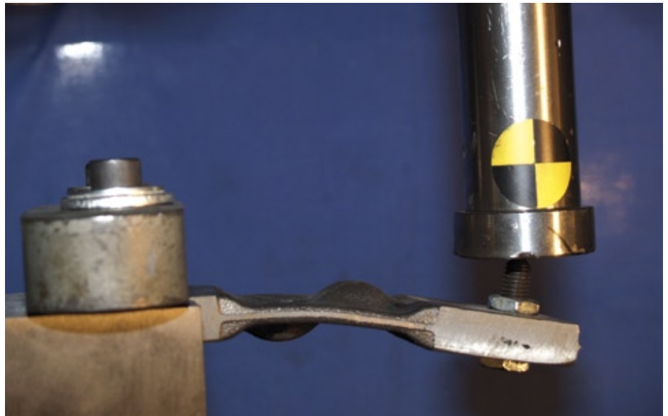
Die i-Speed liefert bei der Schlagprüfung wichtige Informationen zum Verformungsverhalten, zum Rückfedern der Probe und zum zeitlichen Verlauf ihrer plastischen Verformung. Quelle: Georg Fischer Automotive AG
