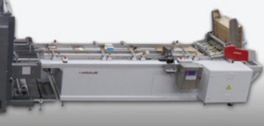
Abb. 2: Handpacklinie für 3-D-Produkte erleichtert das Verpacken von Produkten in Online-Shops oder Versandapotheken. (Foto: Kraus Maschinenbau GmbH)
