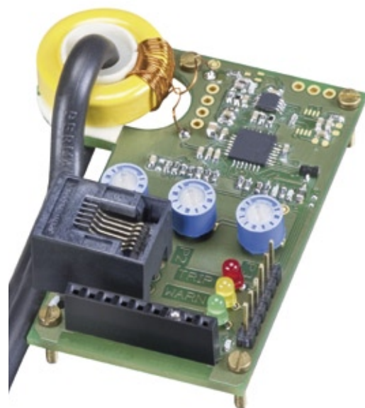
Abb. 2: Prototyp des E-T-A AFD-Sensors
