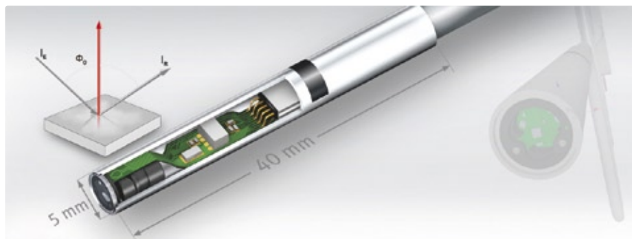
Abb. 1: Grundsätzlicher Aufbau und Arbeitsweise des Schmierfettsensors
