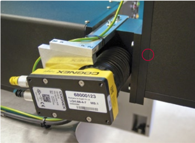
Die In-Sight 5100 ist in den Strahlengang des Lasers eingekoppelt.
