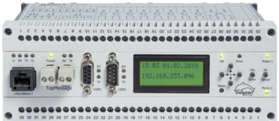
Abb. 3: Das Mess- und Regelsystem TopMessage mit der ProfiSignal-Software von Delphin läuft mittlerweile seit eineinhalb Jahren in der Thermosiphon-Prüfanlage
