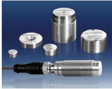
Die Ganzmetall-RFID-Datenträgerfamilie von Contrinex besteht zurzeit aus nicht bündig und bündig einbaubaren Datenträgern mit Durchmessern von 10 mm bis M30. Die Datenträger sind alle beschreib- und lesbar und verfügen über einen Schreib-/Lesespeicher von 2 kBit.
