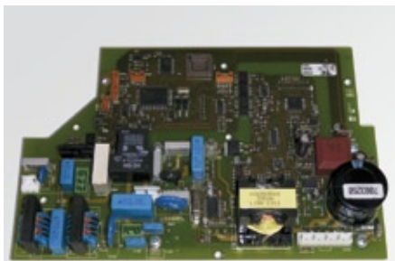
Eine auf die Bauform angepasste Leistungsplatine, die direkt in das Kundengerät montiert werden kann.
