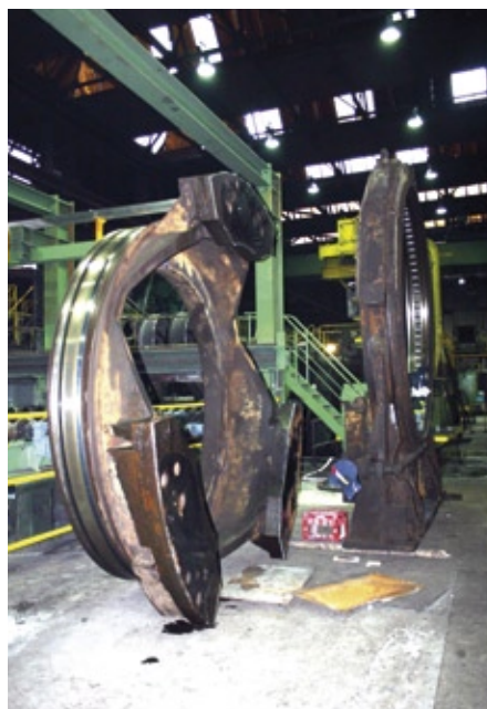
Der Stützring mit Lagerinnenring (links), das Lagergehäuse mit Rollen, Käfig und Außenring (rechts)
