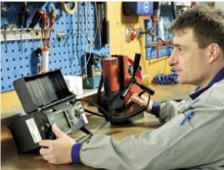
Abb. 3: Messung der elektrischen Sicherheit mit dem Secutest SII +
