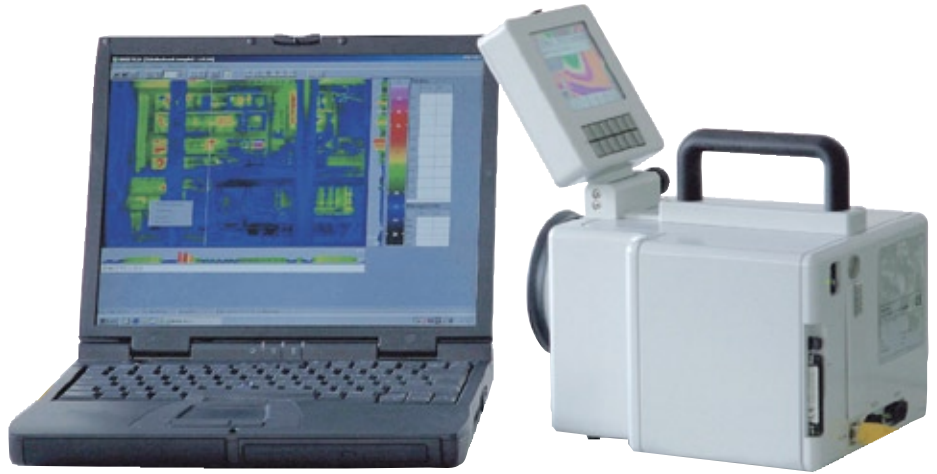
Per Wärmebildkamera lassen sich temperaturkritische Punkte erkennen und durch gezielte Maßnahmen entschärfen.
