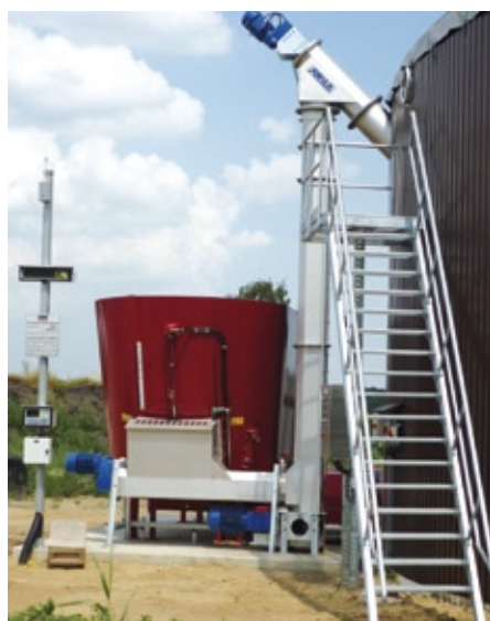
In diesem Behälter werden die Feststoffe, etwa Maissilage, gesammelt und durchmischt, bevor sie in den Fermenter gefördert werden.
