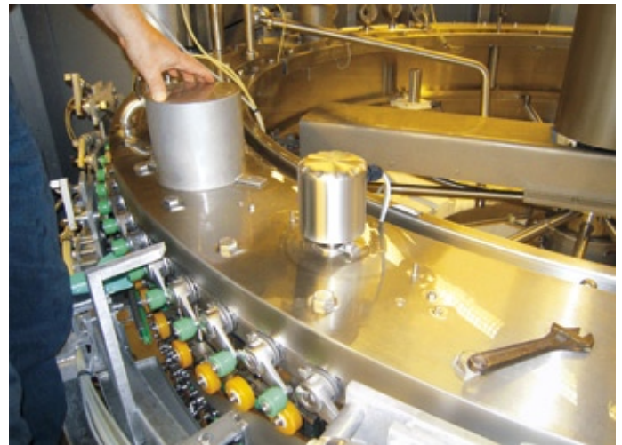
Der LSP 050 misst Füllstände von allen homogenen Flüssigkeiten und wandelt die Messung direkt in ein 4-20-mA-Signal um. Bild: Baumer
