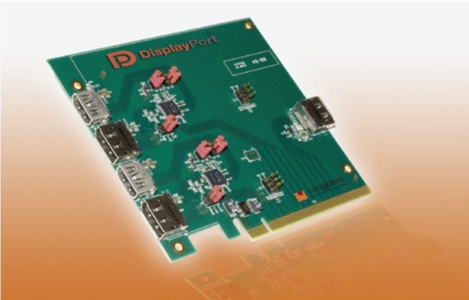
Einsteckkarte conga-ADD2DP für den PEG Slot zur Bereitstellung der DisplayPort- oder HDMI-Signale
