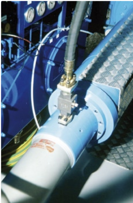
Im Vordergrund – Der eingebaute Hydraulik-Zylinder von Hänchen
