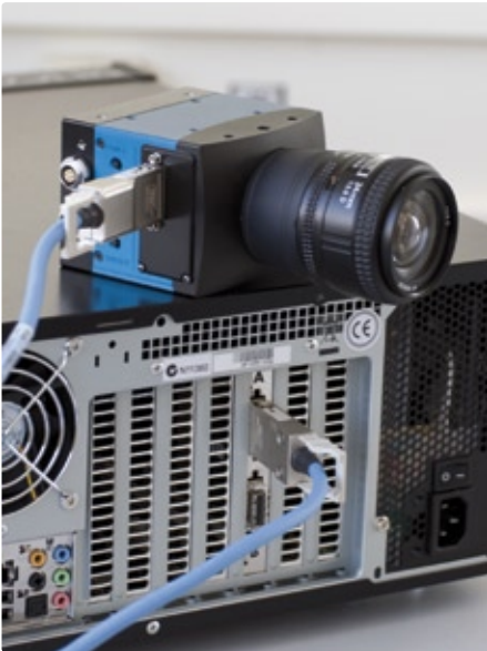
Abb. 2: Prototyp für Camera Link HS als image processing board, angebonden an die Mikrotron CL4 HS
