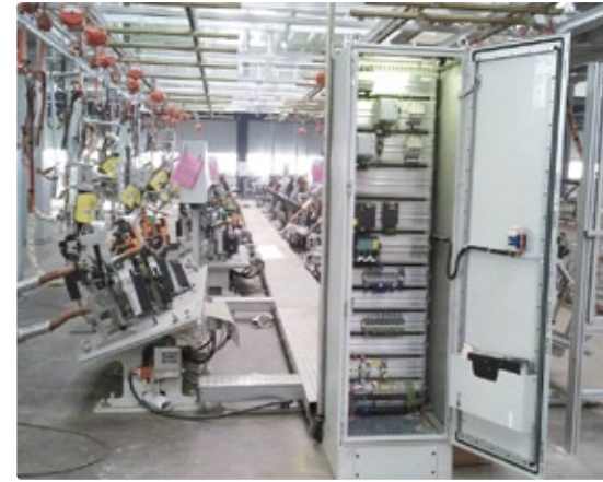
Durch den Einsatz von Profisafe können 20 Vorrichtungen an einer Steuerung betrieben werden.
