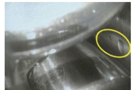
Wälzlager mit Ausbrüchen und Materialabtrag.
