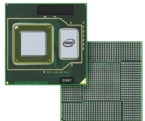
Die E600C sind mit einem FPGA von Altera ausgestattet.
