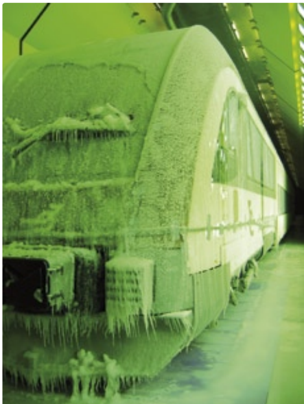
Schienenfahrzeug unter extremen Klimabedingungen im Klimawindkanal (Foto: RTA)
