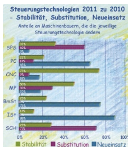
Abb. 2: Steuerungstechnologien 2011 zu 2010 – Stabilität, Substitution, Neueinsatz. MP=Mikroprozessorsteuerung, BmSt=Bedienterminal mit integrierter Steuerung, IST=Integrierte Steuerungsplattform, SCH=Schütztechnik.
