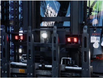
Die Lesegeräte verfügen über eine Hochleistungsbeleuchtung, wodurch sie auch bei schwierigem Umgebungslicht alle Codes problemlos lesen.
