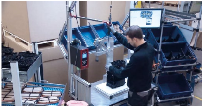
Das Montageassistenzsystem leitet Mitarbeiter mit einer digitalen Anleitung Schritt für Schritt an, wie hier bei der Filtermontage bei Mann + Hummel.
