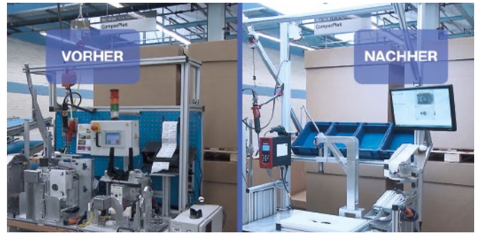
Mit dem Montageassistenzsystem sank die Komplexität der Aufgabe für den Werker deutlich.
