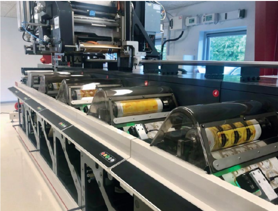
Jede der sechs Druckeinheiten der Etikettendruckmaschine von Nilpeter verfügt über eine B&R-Kamera.
