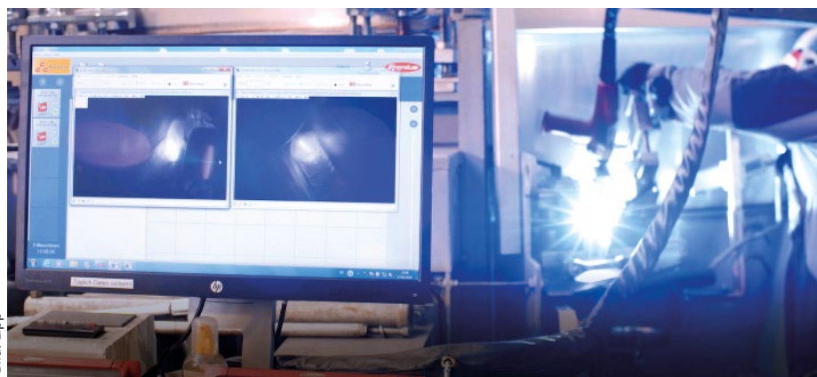
Das intelligente Kamerasystem ermöglicht auch bei extremen Lichtverhältnissen rund um den Lichtbogen ein klares Bild des Arbeitsfelds und damit die Überwachung am Monitor.
