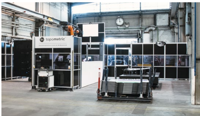
Die optische Doppel-messzelle auf Laserlichtbasis vermisst Bauteile bis zu einer Größe von 4,4 x 2 m.
