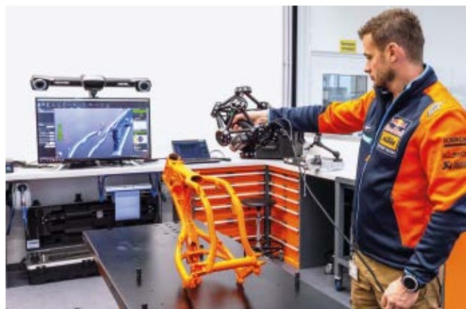
Mit dem 3D-Scanner lässt sich der Rahmen des Sportmotorrades schnell auf Fertigungsfehler oder Abweichungen während des Rennstreckeneinsatzes prüfen.
