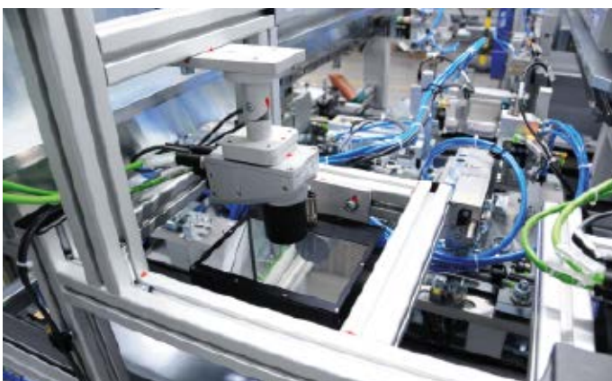
Smartkameras von Balluff führen die finale Verrastungsprüfung der Stecker durch und überprüfen die Abstände der Rastungen zum Steckergehäuse.
