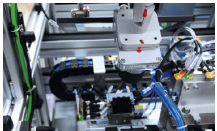
64er-, 32er- oder 24er-Stecker? Die Smartkamera erkennt, ob der richtige Steckertyp vorliegt.
