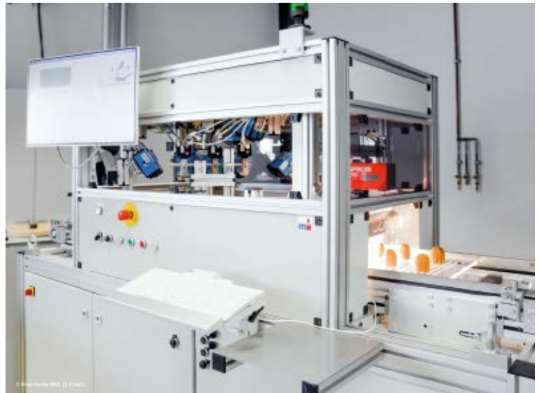
Demonstrationsanlage zum vollautomatischen Prüfen von Holz-, Kunststoff- oder Metallteilen und lackierten Oberflächen
