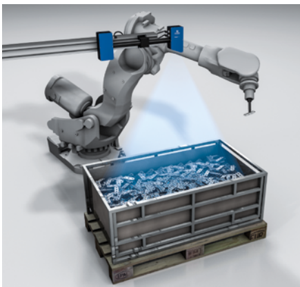
Große Kiste, kleine Objekte: Der 3D-Sensor erfasst die Objekte mit einer Genauigkeit im Mikrometerbereich.
