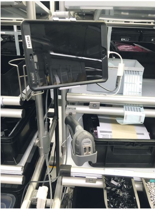
Montagearbeitsplatz mit Codeleser in der Haltevorrichtung
