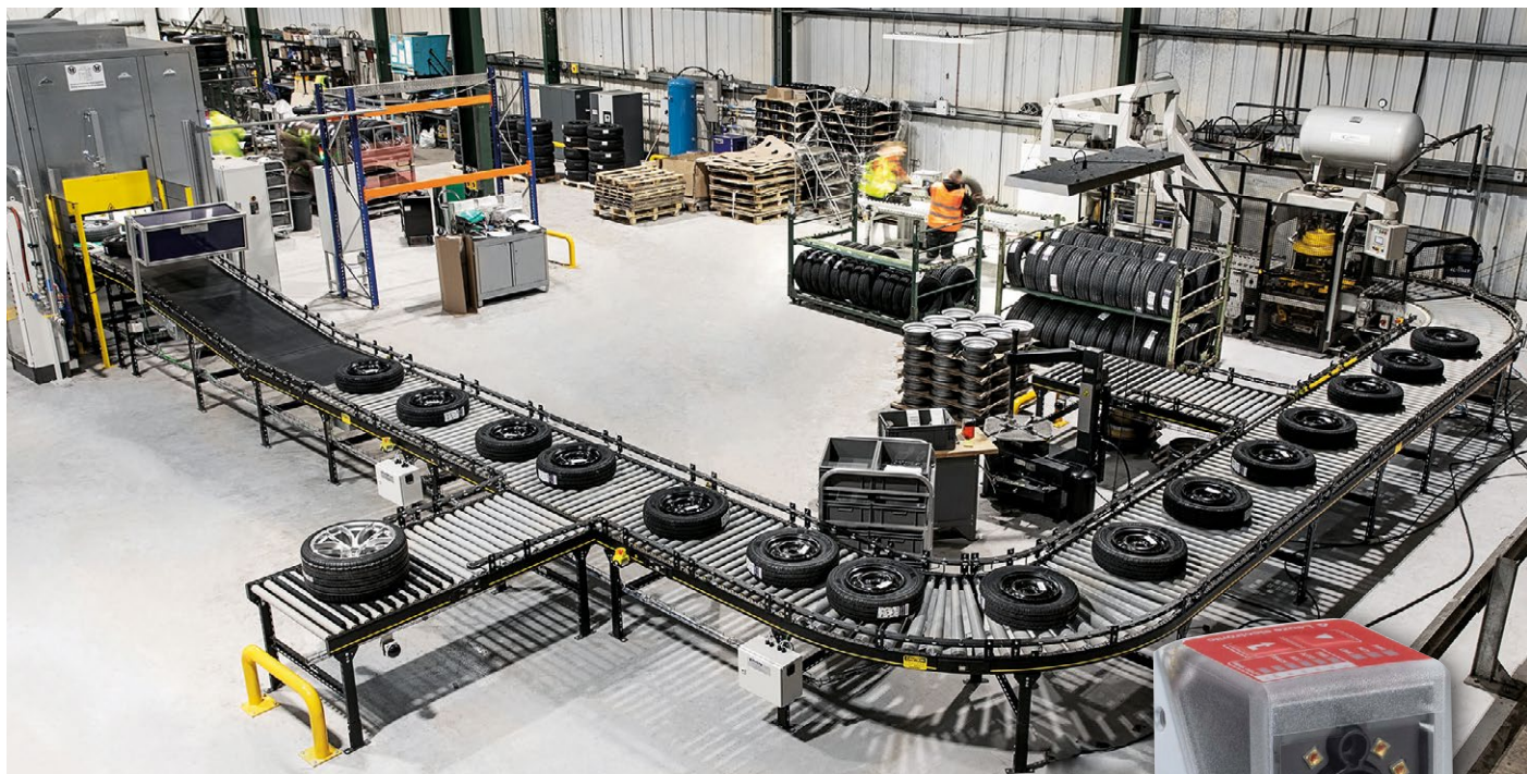
Automatisierte Förderanwendung bei Tyre-Line – von der Baugruppenidentifikation bis zur Reifenbefüllung
