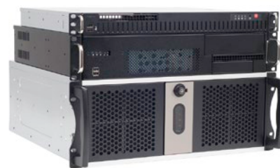
Beispiel eines Vision-PCs mit Steuerung und Spannungsversorgung in einer 19"-Rack-Ausführung
