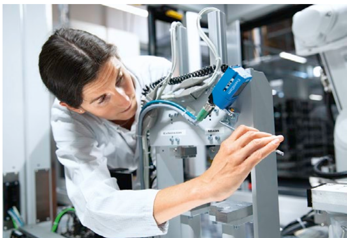
Aufgrund ihres geringen Gewichtes, der kompakten Bauform, der vielseitigen Befestigungsoptionen am Gehäuse und des optionalen Montagezubehörs lässt sich die Eventcam sehr vielseitig einsetzen.
