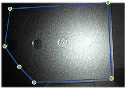
Abb. 3: Bohrlochprüfkörper in unkontrollierter Umgebung mit schwierigen Lichtverhältnissen in 70mm Abstand: Visualisierung des ausgewählten 2D-Bereichs, der als Input für die 3D-Rekonstruktionspipeline dient.
