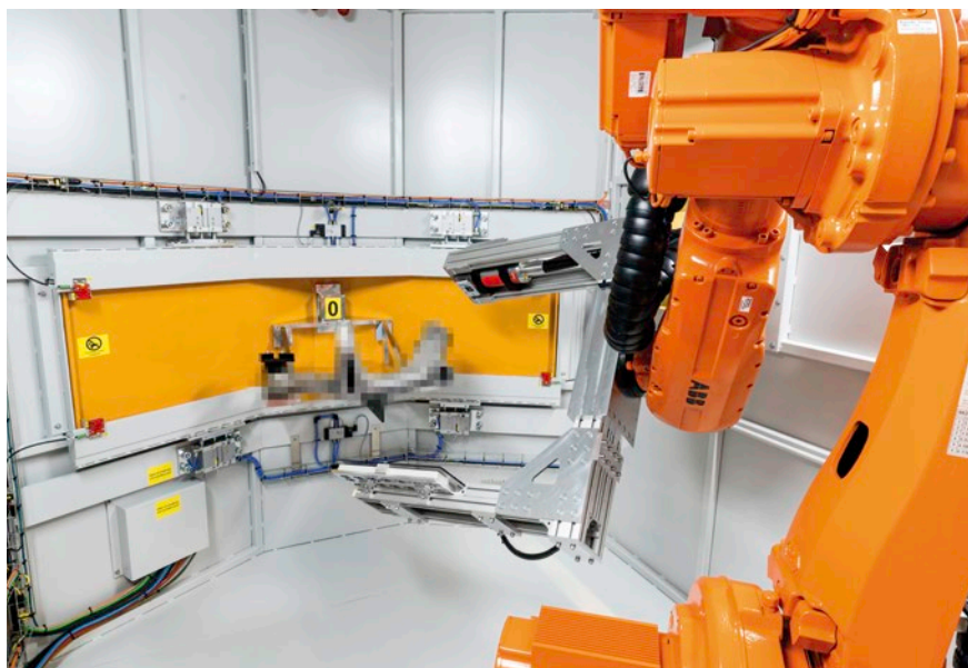
Ein Röntgen-C-Arm fährt ein Bauteil zur Bildaufnahme ab.
