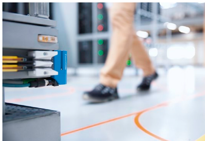
Wird der ungeplante Stopp eines FTS während der Transportfahrt durch eine Person ausgelöst, erkennt dies die Eventcam.
