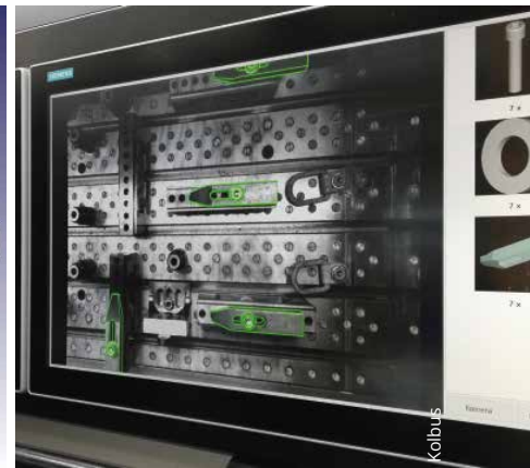
Abb. 1: Ein mit Augmented-Reality ausgestatteter Montagearbeitsplatz, CAD-Modell der zu montierenden Baugruppe, lagekorrekte Visualisierung der Bauteile eines Arbeitsschritts
