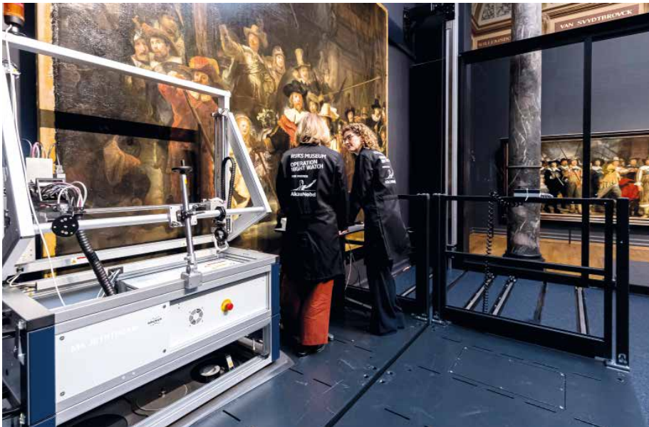
Das M6 Jetstream Mikro-RFA-Spektrometer wurde in Zusammenarbeit mit der Technischen Universität Delft (Niederlande) speziell für die schnelle und zerstörungsfreie Vor-Ort-Untersuchung von großformatigen Objekten, wie Gemälden in Museen, entwickelt.
