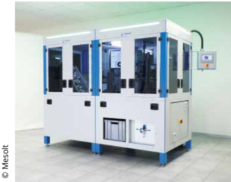
Die standardisierte Prüfanlage kommt bei schnellen Taktzeiten und einer hohen Teilevielfalt zum Einsatz.
