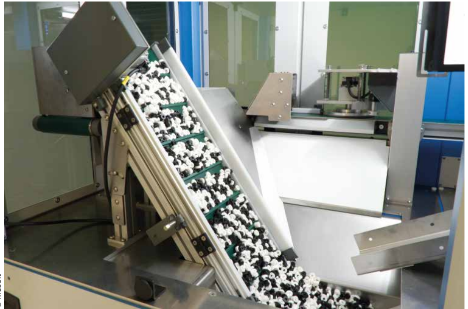
Das Zuführmodul transportiert die Prüfteile in das Prüf- und Sortiermodul.
