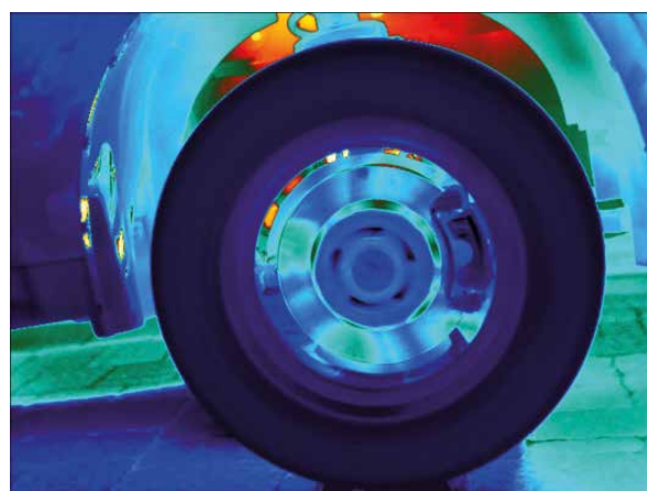
Bewegungsunschärfe bei Bremstest mit ungekühlter Wärmebildkamera mit 60 Hz Bildwiederholgeschwindigkeit
