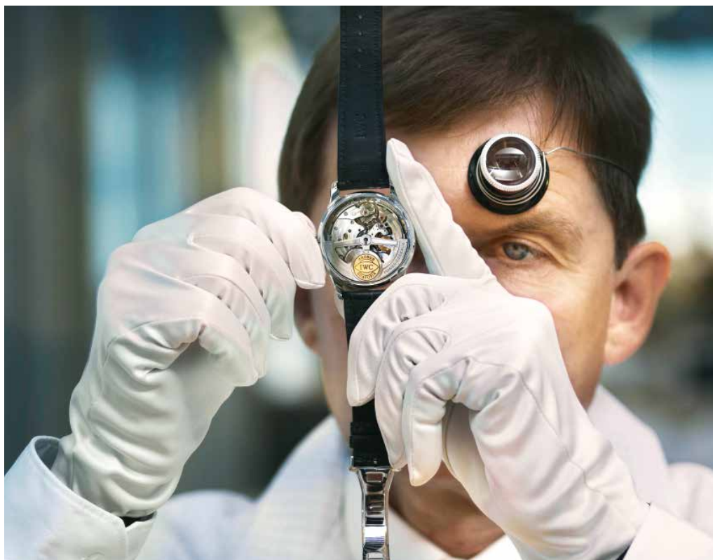
In der Endkontrolle werden alle Uhren funktionell und visuell geprüft und im Falle von Abweichungen unmittelbar instand gesetzt und erneut geprüft.
