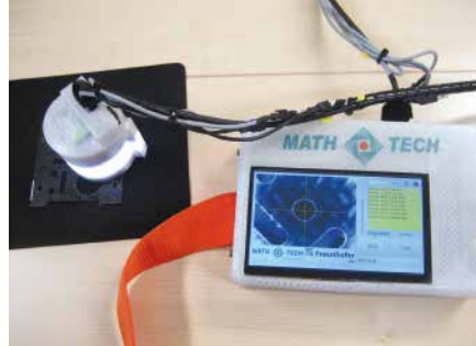
Mobiles Handheldgerät zur Fehlererkennung und Klassifizierung
