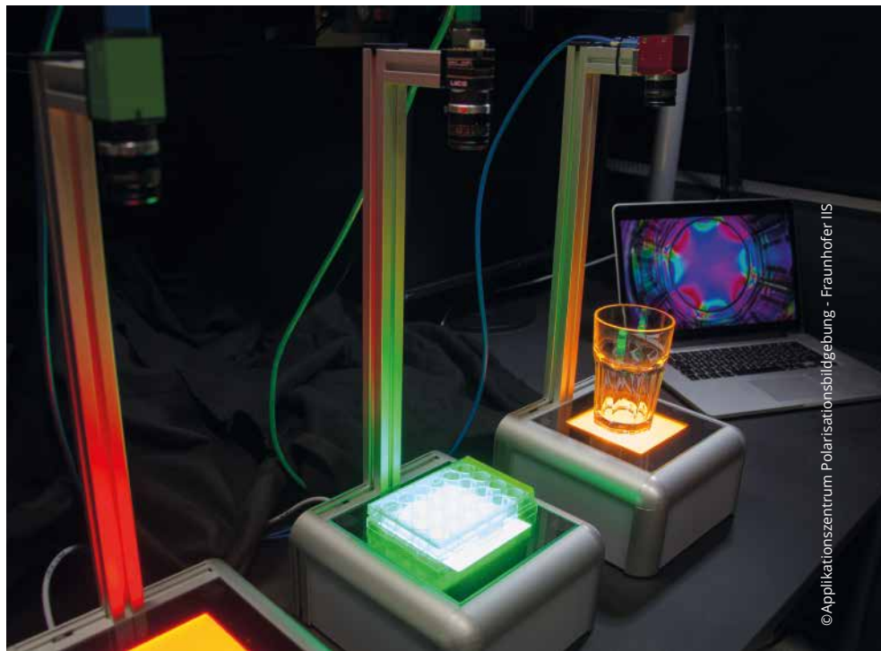
Die Polarisationsbildgebung ist ein neuer Ansatz zur Qualitätsprüfung u.a. von Glas, Kunststoffen oder CFK.
