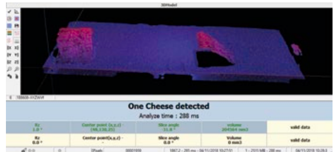
Abb. 3: Die Position des Käsestücks wird aus einem dichten 3D-Bild berechnet.
