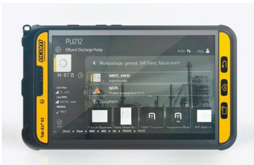
Das Industrie-Tablet Tab-Ex 02 ermöglicht es mittels AR-Anwendungen, Objekte einer Anlage zu identifizieren und Daten in Echtzeit auf das Display zu liefern.
