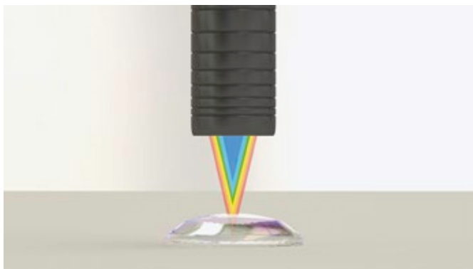
Das konfokal-chromatische Messsystem, bestehend aus dem Sensor ConfocalDT IFS2405-3 und dem Controller ConfocalDT IFC2461, prüft die Mitten- dicke von dünnen optischen Linsen sowie deren Kontur bzw. Krümmung.
