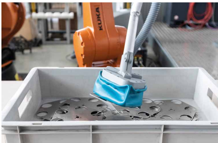
Maschinelle Lernverfahren helfen, dass Roboter den Griff-in-die-Kiste auch bei dünnen, glänzenden Blechteilen schneller und zuverlässiger ausführen.
