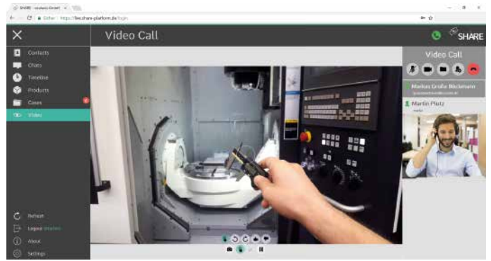
Remote Support mit Datenbrillen zur Lösung akuter Störungen in der Fertigung
