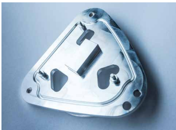
Auch komplex geformte Bauteile – wie dieses Testteil aus Aluminium – lassen sich im freien Fall auf gewünschte Beschichtungen und unerwünschte Verunreinigungen untersuchen.
