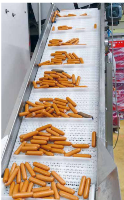
Nach dem automatischen Peelen werden die teilweise noch mit Kunstdarmresten behafteten Würstchen zur Sortieranlage gefördert.
