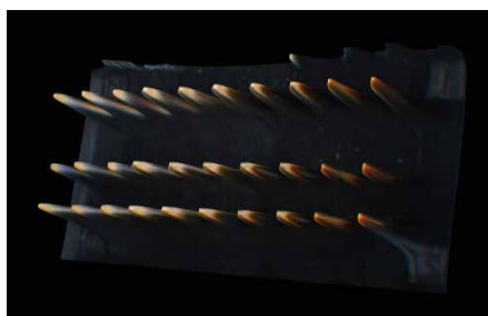
Abb. 3: Aus der Disparitätsschätzung berechnete Rekonstruktion des Elektrosteckers, dargestellt als Point-Cloud.
