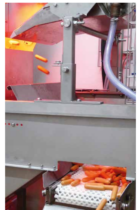
Spezialventile blasen Würstchen mit Darmresten punktgenau mit entkeimter Luft aus. Der Rest wird dem Produktionsprozess wieder zugeführt.
