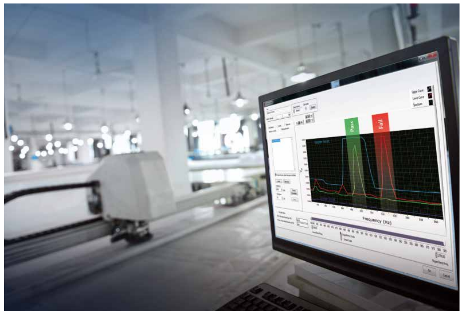
Laservibrometer für zuverlässige OK/nOK-Entscheidungen bei 100%-Kontrollen in automatisierten Fertigungsverfahren. Im Bild: Die Prüfsoftware QuickCheck stellt Toleranzen als Hüllkurven dar.
