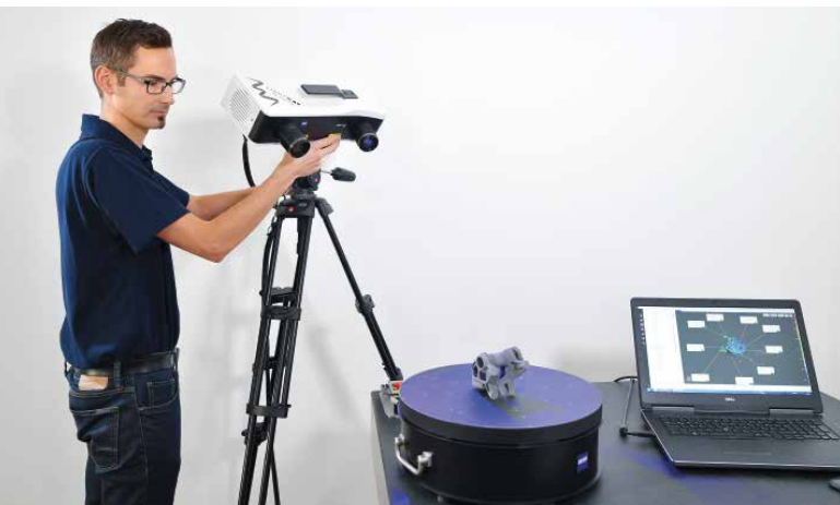
Pascal Schäfer richtet den 3D-Sensor Zeiss Comet ein. Für ihn ist das gesamte System „ausgesprochen einfach zu handeln und sehr intuitiv“.
