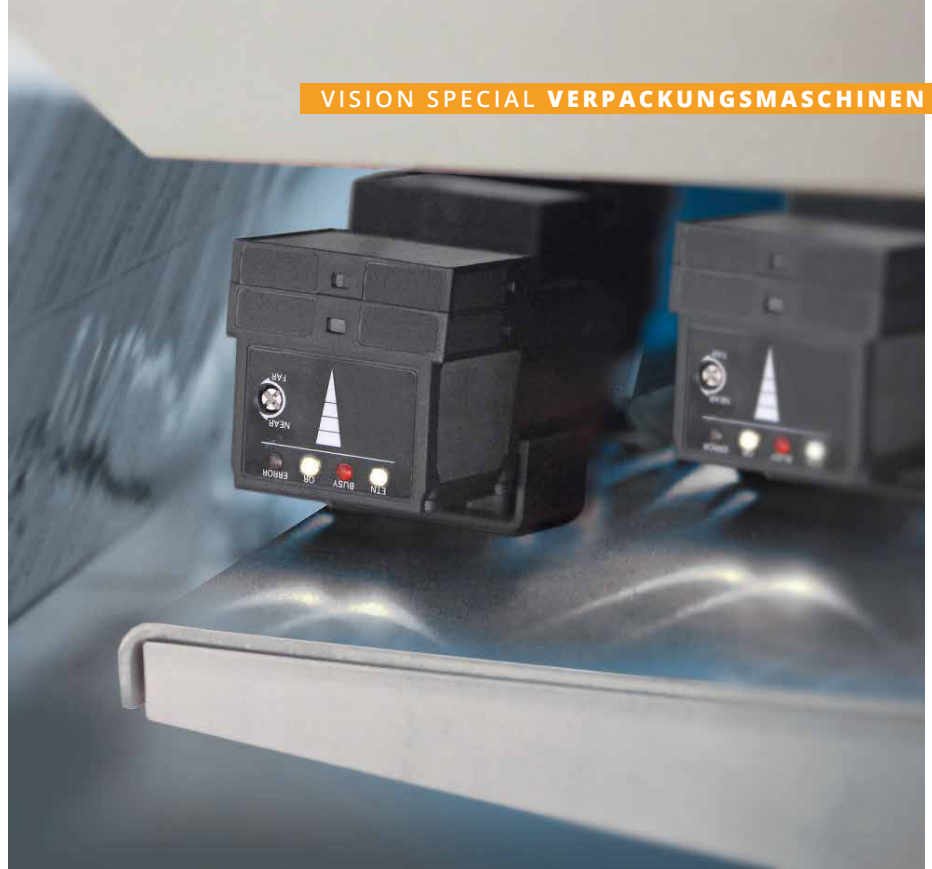
Jede FQ2-Smart-Kamera liest, was der Lasermarkierer geschrieben hat, und sendet diese Informationen als String via Ethernet an die SPS.
