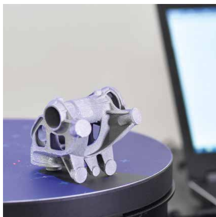
Das aus Titan gedruckte Roboter-Sprunggelenk auf dem Drehtisch des Zeiss-Systems
