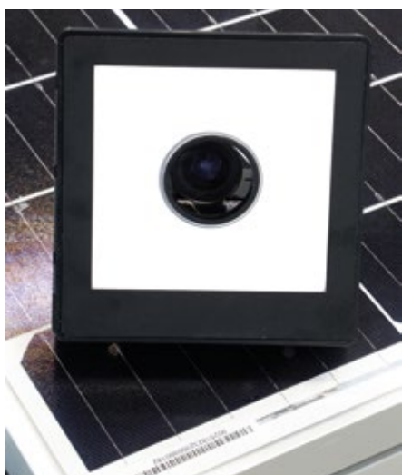
Die indirekte seitliche Einkopplung des LED-Lichtes ermöglicht eine sehr flache Bauweise. Die interne Streuscheibe gewährleistet eine diffuse und gleichzeitig homogene Lichtauskopplung.
