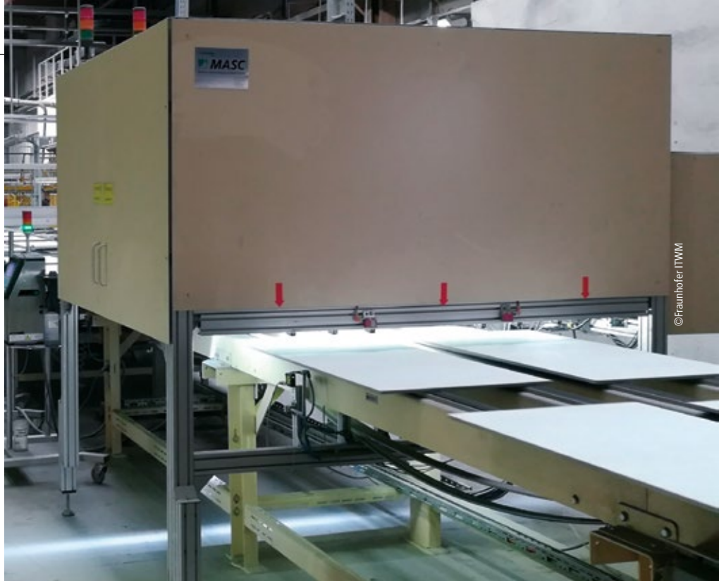
Abb. 1: System zur Inline-Inspektion von Deckenplatten
