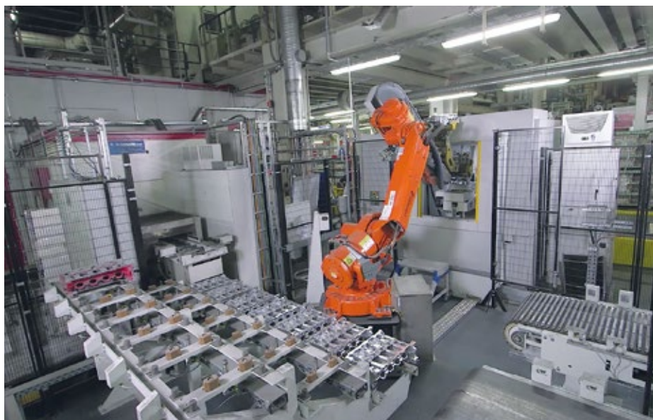
Ein Roboter bestückt Zeiss VoluMax automatisch mit den zu prüfenden Gussteilen. Zylinderköpfe, deren Messergebnisse unauffällig sind, legt der Roboter auf das rechts im Bild zu sehende Förderband.
