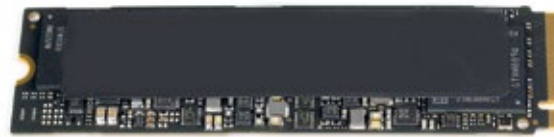
Für Anwendungen, die eine große Anzahl von Einzelbildern auf ein Speichermedium speichern, werden NVMe Solid-State-Laufwerke (SSD) empfohlen.
