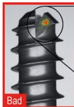
ViDi Red Analyze segmentiert Bereiche und erkennt Fehler.
