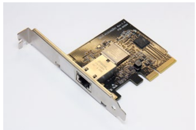
Damit NICs sicher die volle PCIe-Bandbreite zur Verfügung steht, sollten sie in Steckplätzen sitzen, die keine Bandbreite mit integrierten Peripheriegeräten teilen.
