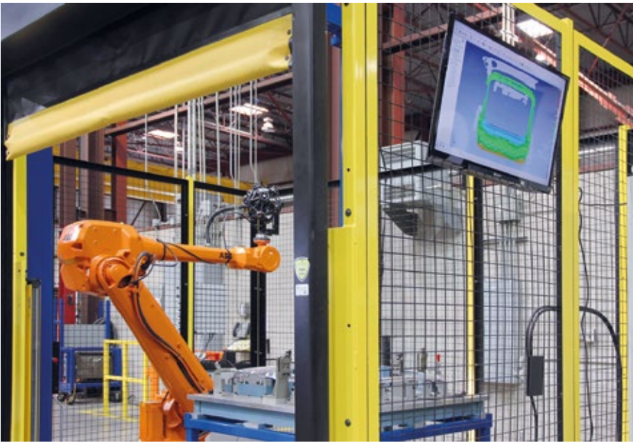
Automatisierte Qualitätskontroll-Lösung, die optische Reflektoren zur Durchführung genauer und wiederholbarer Messung im Fertigungsbereich einsetzt
