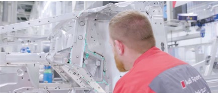
Durch einen definierten, standardisierten Prüfablauf wird jede Schweißnaht immer zum gleichen Zeitpunkt abgefragt.
