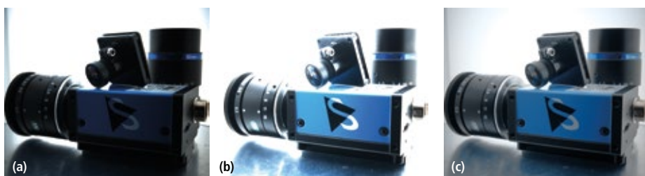
Abb. 2: Beispiel einer Belichtungsreihe bestehend aus zwei Aufnahmen mit kurzer (a) und langer (b) Belichtungszeit. (c) Aus der Belichtungsreihe errechnetes und durch Tone-Mapping visualisiertes HDR-Bild.
