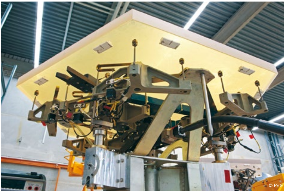
Abb. 2: Der Hauptspiegel soll aus 798 hexagonalen Einzelsegmenten zusammengesetzt werden, die jeweils einen Durchmesser von 1,4 m haben und ca. 250 kg wiegen. Jedes Spiegelement wird von drei Antrieben positioniert.
