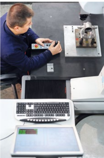
Durchführung einer messtechnischen Kontrolle mit herkömmlicher Technik im Messraum
