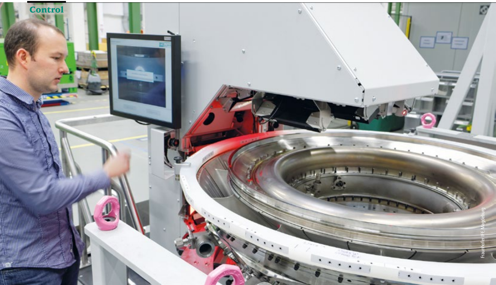
Abb. 1: Handgeführter optischer Prüfassistent in der Triebwerksmontage
