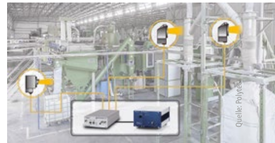
Abb. 7: Mit einem optischen Multiplexer kann eine anwendungsspezifische Konfiguration mit verschiedenen analytischen Fragestellungen kostengünstig realisiert werden.
