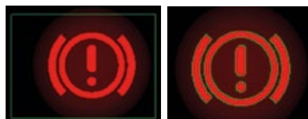
Vergleich statische, per Hand in der Software erstellter POI mit Auto-POI (Automatic Points of Interest) angepasst an ein Objekt basierend auf Farbtoleranzen
