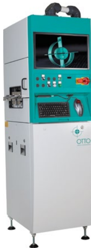
In der schmalsten Variante sind die Stanzstreifenprüfgeräte PSS-40 von Otto Vision Technology nur 550 mm breit.
