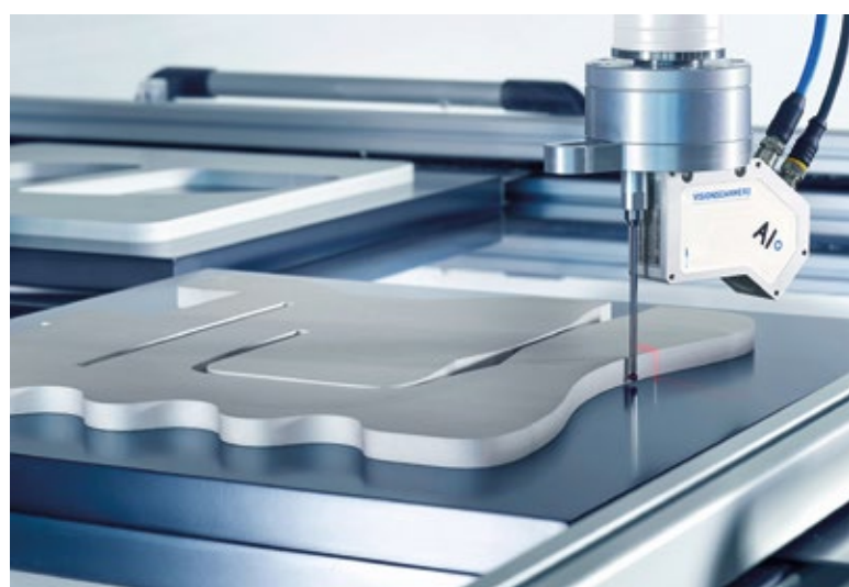
▲ Abb. 5: Die Konfiguration Inline Process Inspection (hier ein Prototyp) ermöglicht die Steuerung einer Roboterbahn mit gleichzeitiger Regelung einer Applikation in Echtzeit (angedeutet durch eine Messspitze)
