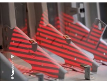
Optische Erfassung mit dem am Roboter montierten optischen 3D-Sensor (l.), Vergleich der 3D-Messdaten mit dem geometrischen CAD-Modell (Mitte) sowie kontextabhängige Generierung von Zustands- und Korrekturhinweisen (r.)
