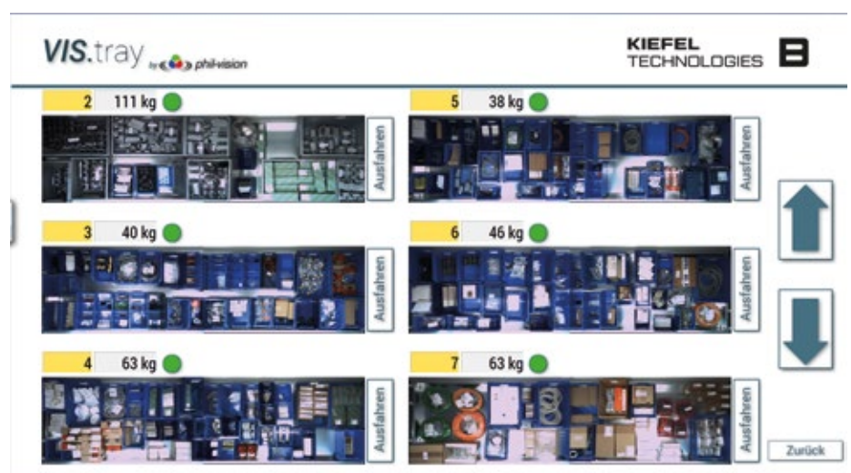
Via Scrollen erhält der Bediener einen schnellen Überblick, welche Tablare noch Platz- und Gewichtskapazität für das Einlagern weiterer Teile haben.
