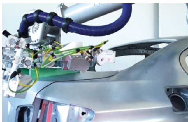
Abb. 4: Die Konfiguration Robot Guidance Advanced beschreibt das AI System zur Anbauteilmontage im Automobilbau mittels Multisensorsystem inklusive Berechnung aller involvierten Bauteile, Reportingtool in einem Qualitätsregelkreis. ▼
