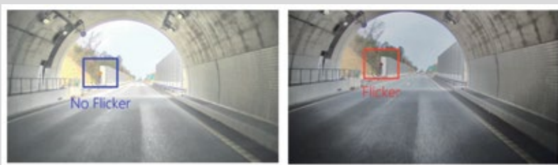
Abb. 1: Vergleichsbeispiel: Gleichzeitige LED-Flackerreduzierung und HDR-Funktionen (l.), nur HDR-Funktion (r.)
