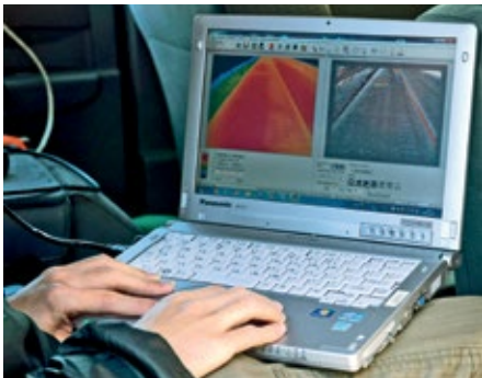
Abb. 6: Infrarot-Livestream von der IrBAS-Software von Nexco-West auf einem Laptop
