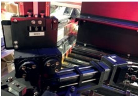
In einem der Synergx Kanten-Periskope ist eine Spyder Kamera von Teledyne Dalsa installiert.
