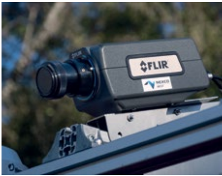
Abb. 5: Flir A6701sc-Kamera für die Erstellung von Infrarotkarten von Delaminationen
