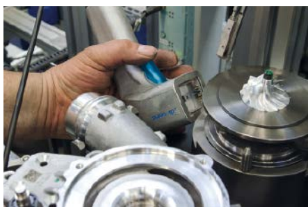
Auch verdeckt angebrachte Codes erfasst der Reader schnell und zuverlässig.
