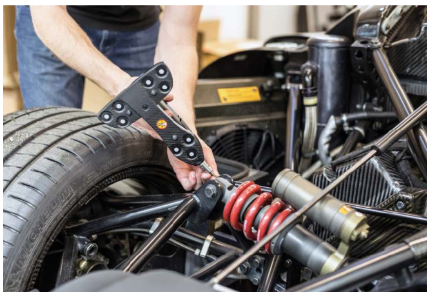
Ohne starren Messaufbau bietet das Handyprobe eine unübertroffene Flexibilität und einen deutlich größeren Messraum als andere tragbare CMMs.
