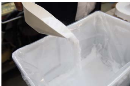
PTFE-Pulver vor der Verarbeitung. Durch Pressen und Erhitzen entstehen bei Beichler + Grünenwald extrem haltbare Kunststoffteile für unterschiedlichste Anwendungen.
