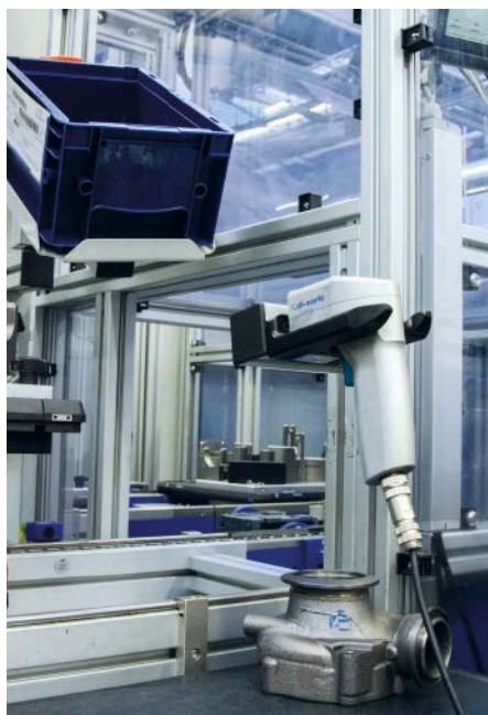
Der Handheld-Reader in der Aufnahmevorrichtung an der Montagezelle
