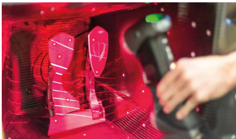
Handyscan 3D-Scanner für die Messtechnik erfassen bis zu 480.000 Messungen pro Sekunde mit einer Genauigkeit von bis zu 0,030 mm.
