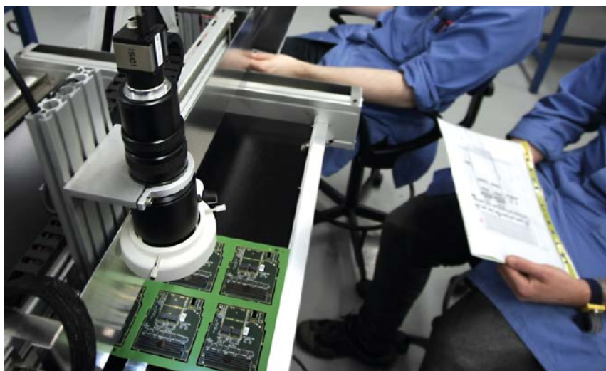
Norcott Technologies prüft seine Erstmuster-Leiterplatten mit einem automatisierten Prüfsystem mit integrierter USB-3.0-Kamera.
