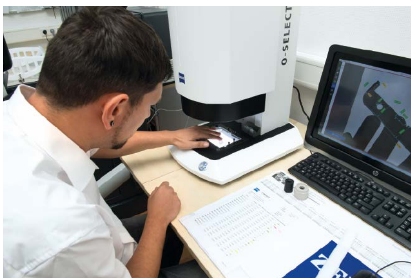
Die Zeiss O-Select bestimmt die Maße von Bauteilen in Sekundenschnelle vollautomatisch und mit verlässlicher Präzision.
