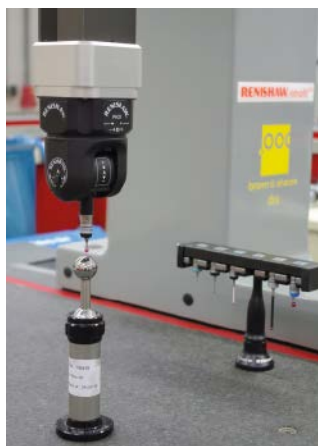
Für Messungen unterschiedlichster Merkmale wechselt das KMG bis zu sechs unterschiedliche Tasteinsätze selbsttätig aus dem Magazin in den Tastkopf ein.
