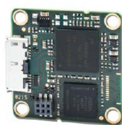
Mögliche Schnittstellen für Embedded-Bildverarbeitung: BCON for LVDS und USB 3.0
