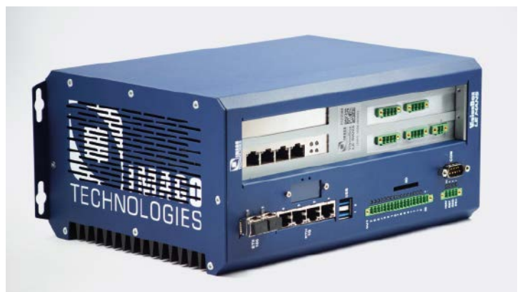
Abb. 5: Die VisionBox Le Mans mit 10 GBit/s Ethernet, PoE, ToE, LED Controller
