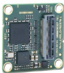
Mögliche Schnittstellen für Embedded-Bildverarbeitung: BCON for LVDS und USB 3.0
