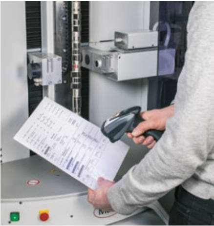
Lokale Intelligenz: Werkstücke werden per Barcode-Reader erkannt.
