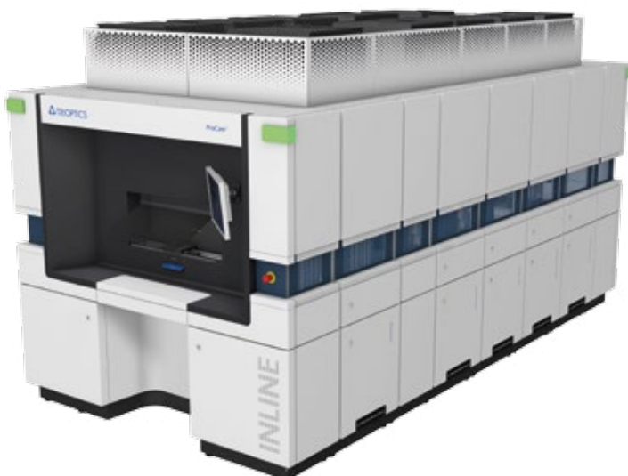
Abb. 1: Teilautomatisierte Kameraproduktionslinie mit Sensortest, Kleberauftrag, aktivem 6-Achsen Ausrichten, UV-Härten und finalen Qualitätstest
