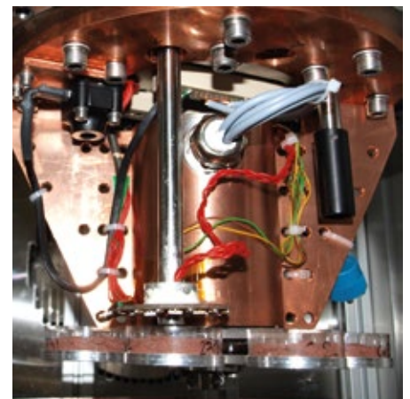
Die weniger als einen Kubikzoll kleine Industriekamera (links oben im Bild) war den rauen Bedingungen in der Simulationskammer voll ausgesetzt.
