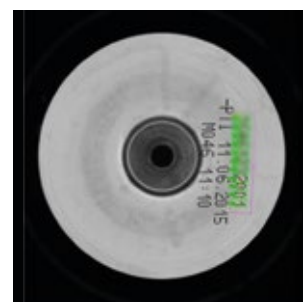
Abb. 7: Station 3 – Prüfungen für den Radrücken (Kamera 4 MP, Auflösung 30 µm): Lesen Klarschrift (Artikelnummer), Lesen DMC, Oberflächenfehler RR Rohstellen
