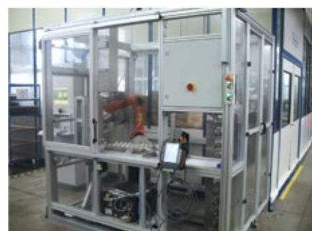
Abb. 8: Anlage zur automatischen Endkontrolle von Verdichterrädern
