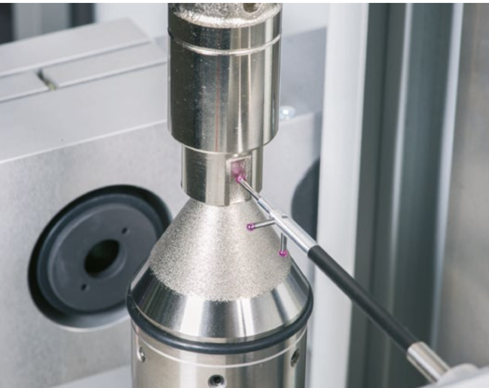
◀ Messung der Passfedernut
