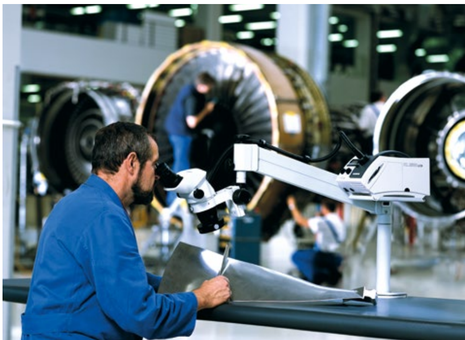
Abb. 6: Stereomikroskop bei der hochauflösenden Sichtprüfung von Turbinenschaufeln
