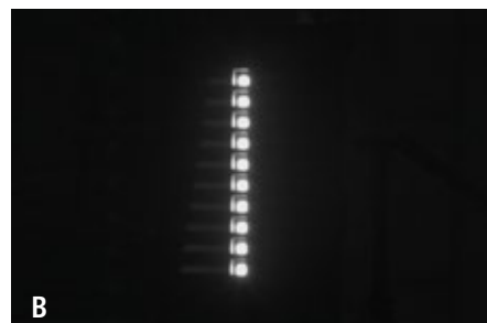
Abb. 2: Vergleich des Smear-Effektes für einen CCD-Sensor (A) und einen CMOS-Sensor (B); beides Bildsensoren mit 5,1 MP
