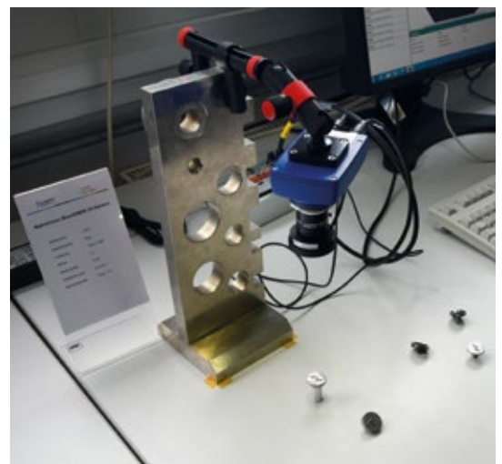
Smart Camera und Software inspizieren die Prägestempel
