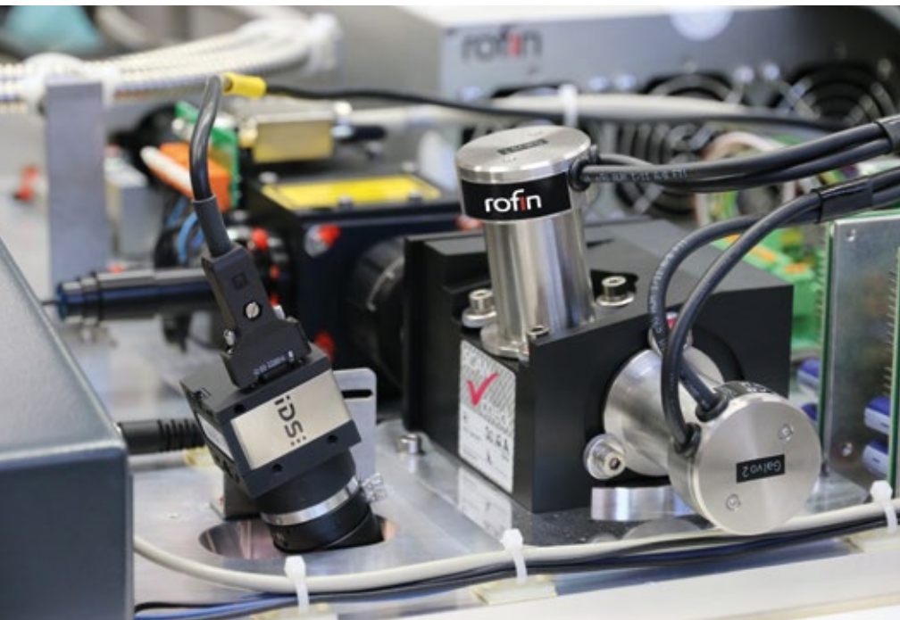
EasyMark Desktop-System mit USB 2 uEye SE Kamera
