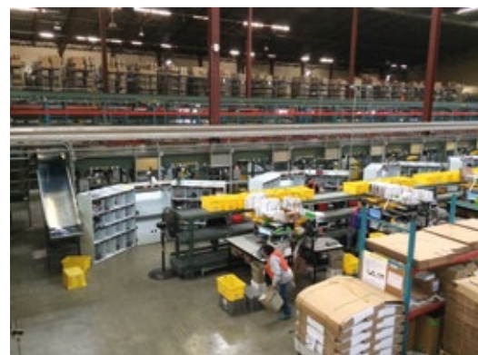
Bei voller Kapazität verarbeitet die EuroSort Linie 28.800 Packstücke pro Stunde, vorausgesetzt, die Artikel-Etiketten werden korrekt gelesen.
