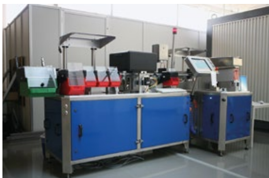
Abb. 2: Automatische Prüfanlagen für die schnelle, präzise Oberflächenprüfung von Polymer-Dichtringen
