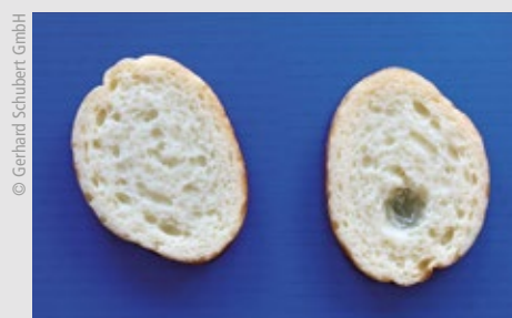
Brotscheiben, die „Ausbrüche“ in Form von Löchern aufweisen, werden vom 3D-Scanner auf dem Förderband erkannt.
