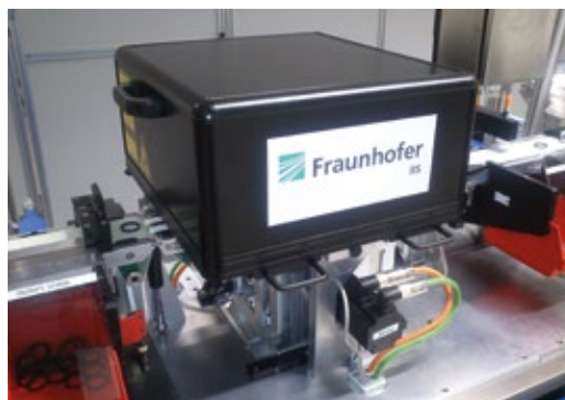
Abb. 4: Eine hochauflösende Messeinheit erfasst die Oberfläche der Dichtringe dreidimensional von allen Seiten.
