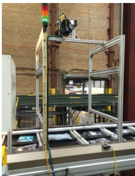
Die Leseratte des Cognex DataMan 503 liegt bei einer Bandgeschwindigkeit von einem Meter pro Sekunde bei 99 %.
