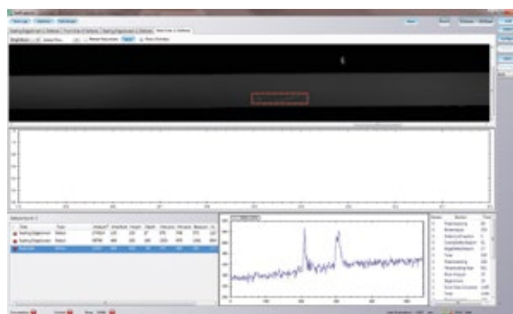
Abb. 5: Screenshot eines Auswertebildschirms, das die Verunreinigung einer Dichtring-Oberfläche anzeigt
