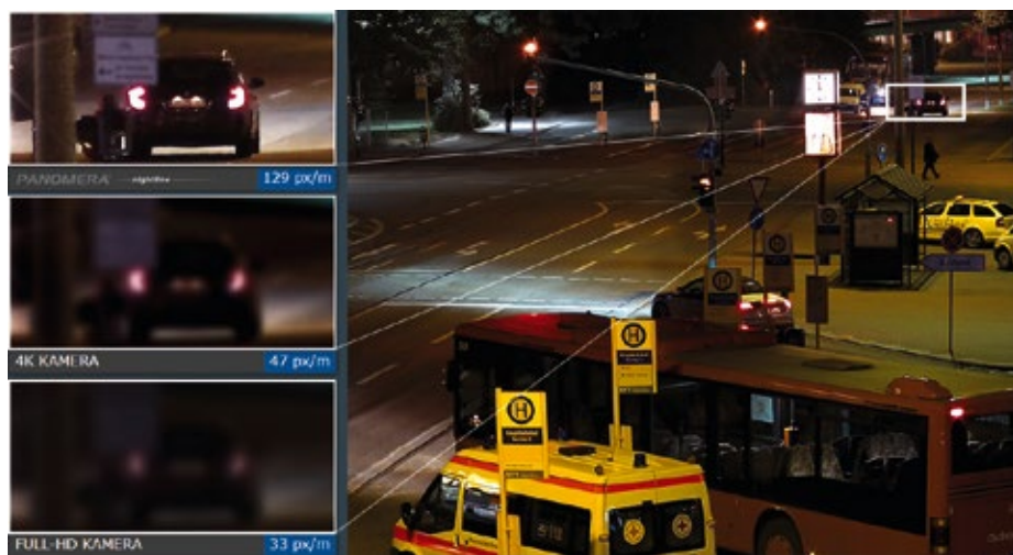
Vergleich der Panomera Nightline mit einer 4K und einer Full-HD Kamera bei einer Entfernung von 200m
