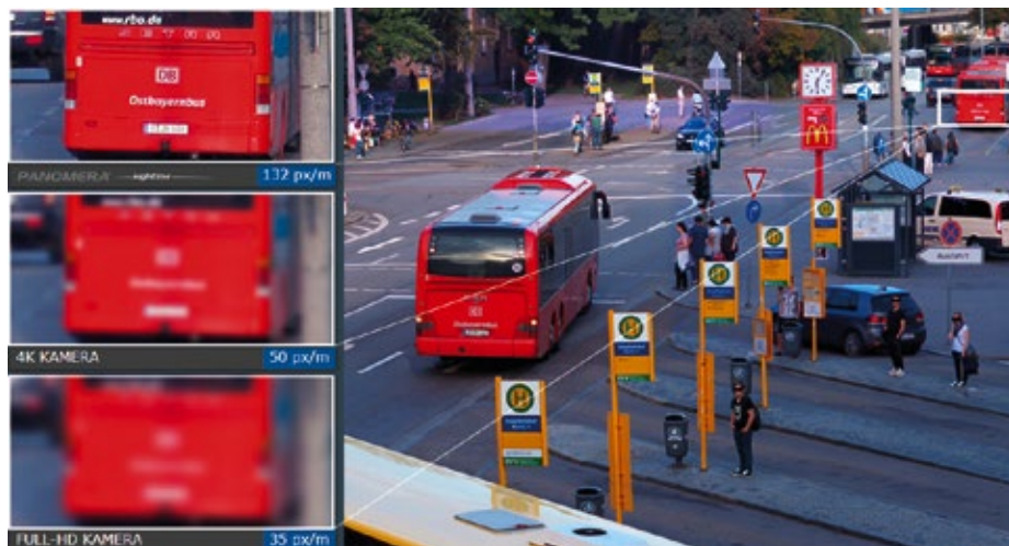
Vergleich der Panomera Nightline mit einer 4K und einer Full-HD Kamera bei einer Entfernung von 150m
