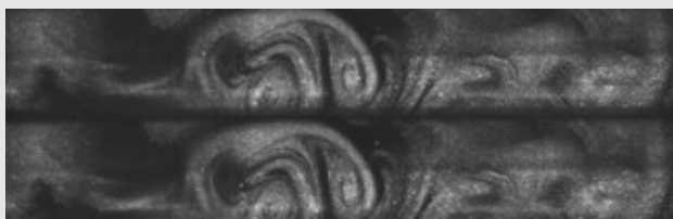
Abb. 1: Zwei schnell aufeinander folgende Bilder eines mit Ölparkeln dotierten Luftstroms als Ausgangsmaterial für die PIV-Analyse.
