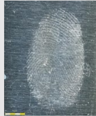
Abb. 3: Latente, mit Baumwolle abgewischte Fingerabdrücke auf Aluminium wurden auf 400°C erhitzt und lichtmikroskopisch mit dem DSX100 unter gerichteter Beleuchtung und maximalem Kontrast sichtbar gemacht. Aufnahme mit freundlicher Genehmigung von K. Dettori, Abertay University
