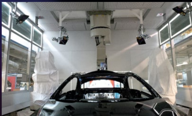
Abb. 1: Mechanischer Aufbau von Kameras und Beleuchtung
