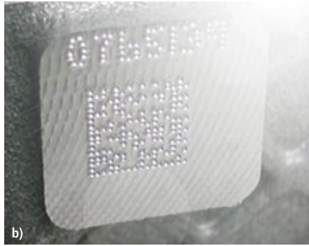
Beispiele für einen genadelten Datamatrix-Code auf einer Metalloberfläche: Schwierige Lesebedingungen durch Verfärbungen (a) oder Fremdlicht aus der Umgebung (b)
