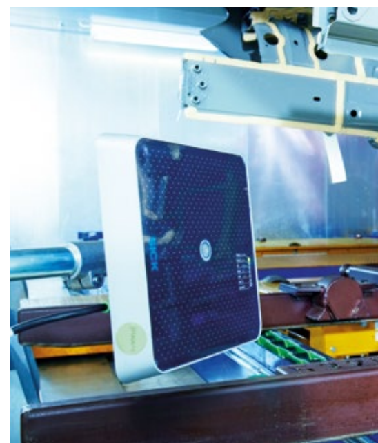
UHF-RFID erkennt Karosserien trotz Hitze und Metall.
