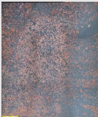
Abb. 2: Von Metalloberflächen abgewischte Fingerabdrücke können durch Erhitzen auf mindestens 400°C wieder sichtbar gemacht werden. Mit Wolle (a) oder mit Nylon (b) abgewischte Fingerabdrücke auf Kupfer, mit Wolle (c) oder mit Baumwolle (d) abgewischte Fingerabdrücke auf Messing, abgebildet mit dem DSX100. Aufnahmen mit freundlicher Genehmigung von K. Dettori, Abertay University
