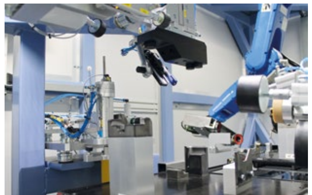
Abb. 2: Ein am Roboter montierter Stereo-Kamerakopf übernimmt die 3D-Vermessung.
