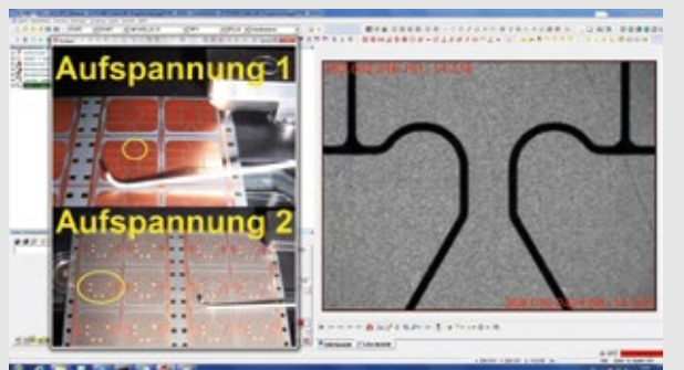
Die serienbegleitende Messung der Leadframes übernehmen die Werker. Die Benutzeroberfläche von PC-DMIS Vision weist den Weg.
