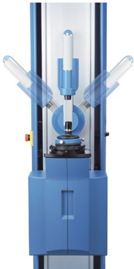
Labormessung der Bildqualität eines Kameramoduls aus verschiedenen Blickwinkeln
