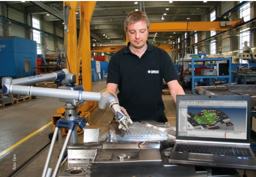
Der Faro-Arm zusammen mit der Messsoftware CAM2 Measure beschleunigte die Messungen von komplexen Freiformflächen gegen CAD-Daten.
