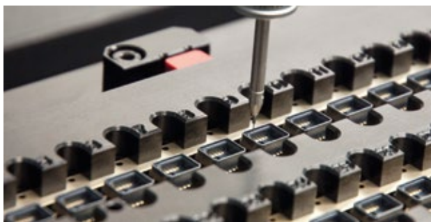
Ein Taster mit einem Tastspitzendurchmesser von 0,3 mm nimmt Gehäusebreite und -länge auf.
