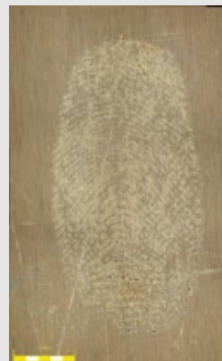
Abb. 2: Von Metalloberflächen abgewischte Fingerabdrücke können durch Erhitzen auf mindestens 400°C wieder sichtbar gemacht werden. Mit Wolle (a) oder mit Nylon (b) abgewischte Fingerabdrücke auf Kupfer, mit Wolle (c) oder mit Baumwolle (d) abgewischte Fingerabdrücke auf Messing, abgebildet mit dem DSX100. Aufnahmen mit freundlicher Genehmigung von K. Dettori, Abertay University
