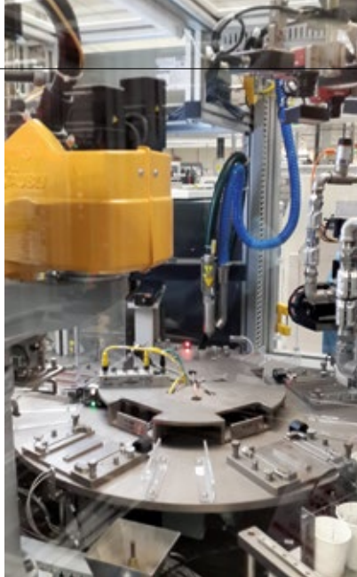
Für die automatisierte Kontrolle der Fertigungsstraße ist hier die in einen Roboterarm integrierte Kamera Vision Hawk von Microscan zuständig.
