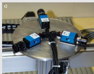
c) Prototyp des CPMS bestehend aus drei The Imaging Source DMK23G274 Kameras auf dem Kalibrierstand
