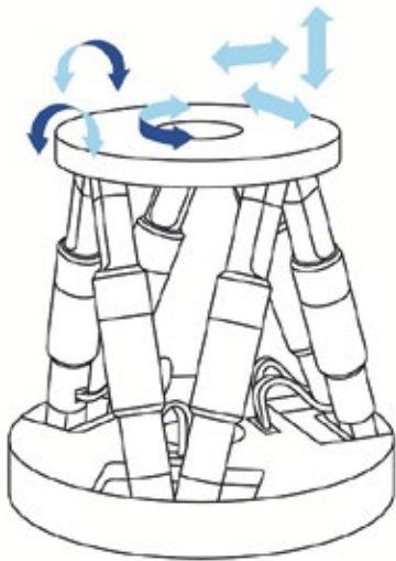
Abb. 1: Prinzipaufbau des Hexapod: Bei parallelkinematischen Systemen wirken alle Aktoren unmittelbar auf die gleiche Plattform.
