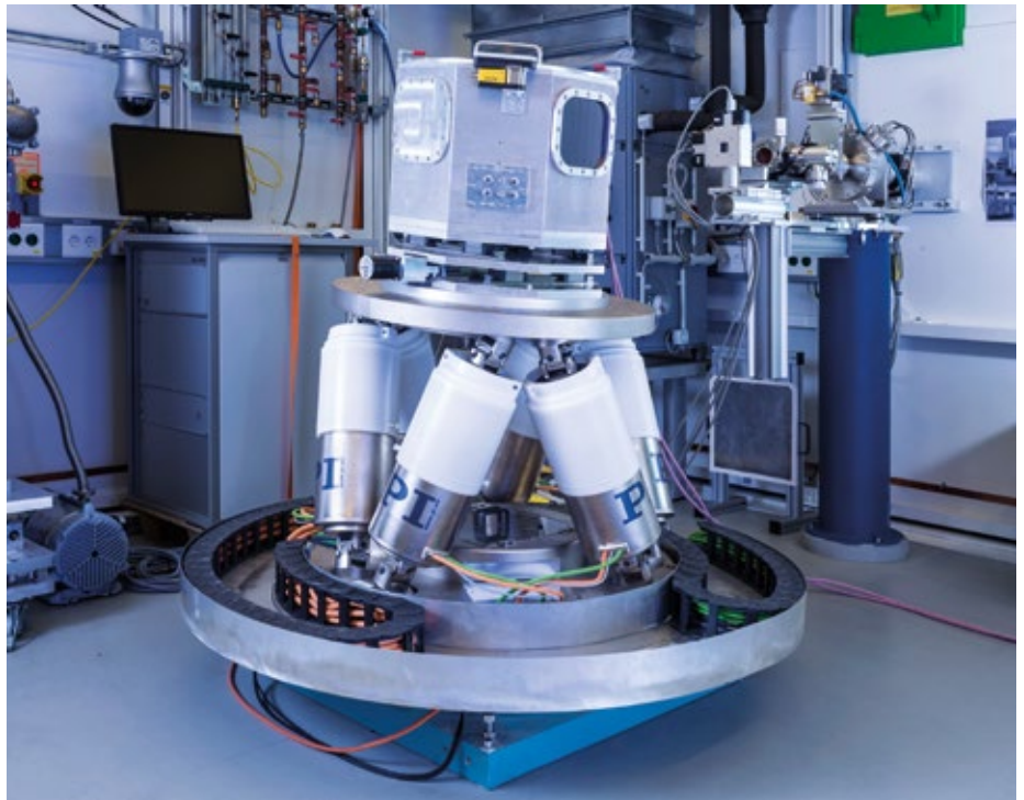
Abb. 2: Hexapod in der Experimentierhütte EH3 der Strahlführung P07 an PETRA III. Im Bild eine Kammer zum Laserschweißen von Titanaluminiden
