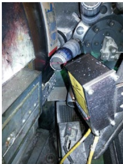
Abb. 2: In der Drucklinie installierter Gocator 3D-Smart-Sensor
