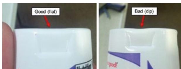
► Abb. 1: Beispiel einer ebenen (guten) Becheroberfläche (l.) und einer eingezogenen (schlechten) Becheroberfläche (r.)
