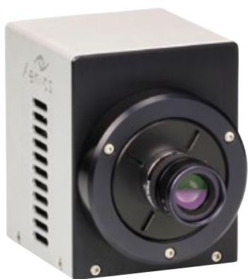
Die beim Hyperspectral Imaging eingesetzte Kamera Xeva-1.7-320 von Xenics
