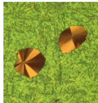
Abb. 1: Squarainfarbstoffe unter polarisiertem Licht. Diese molekularen Farbstoffe bieten eine nachhaltige Alternative für die photoaktive Schicht, hier dargestellt zwischen gekreuzten Polarisatoren mit dem Lext OLS4100 von Olympus. links: Einzelne Kristalle zeigen einen goldenen metallischen Glanz; rechts: Aufgeschleuderte Beschichtung mit unverdünntem Squarain, mit Sphärolithaggregaten, die sich bei der thermischen Bearbeitung durch Kristallisation bilden
