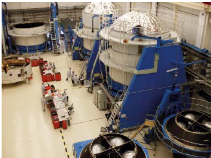
In der Montagehalle stehen drei Oberstufen der Ariane 5. Jede der Stufen wird nach Zündung die Schubkraft für 10 t Nutzlast entwickeln.
