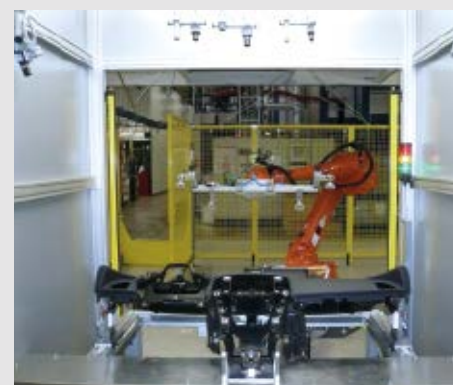
Detailansicht: Vollautomatische Cockpitprüfzelle
