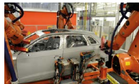
Vier Messroboter erfassen die Spalte vor der Übergabe an die Lackiererei.
