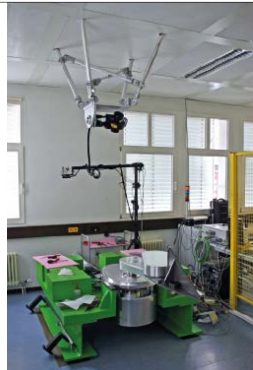
▲ Vakuumroboter von Asys: An der Decke hängt ein API Tracker3, der die Position des Endeffektors dynamisch misst. Die 6DOF-Information wird durch das Messen passiver, auf den Effektoren angebrachter Spiegeltargets bestimmt.
