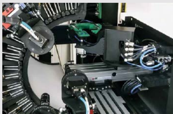
Abb. 3: Das Oberflächenprüfsystem SurfMax besteht aus einem 4-Achs-Bewegungssystem zur Inspektion von Freiformteilen.
