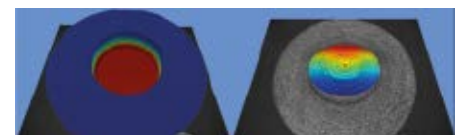
Abb. 1: Auch tief liegende Flächen können erreicht und charakterisiert werden, z. B. die Innenfläche eines Werkstücks (links: Gesamtmessergebnis; rechts: Detaildarstellung der tief liegenden Fläche).
