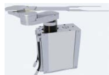
Der Vario V Single 780 KH von Asys ist der Standardroboter für gängige Hochvakuumanwendungen.
