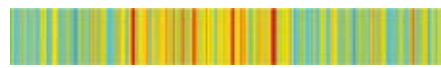
Abb. 2: Analyse großer Oberflächen. Beispiel einer Messung über eine Länge von 5 mm durch Aneinanderfügen (Stitching) von 20 Einzelbildern. Messdauer: 0,7 Sekunden.
