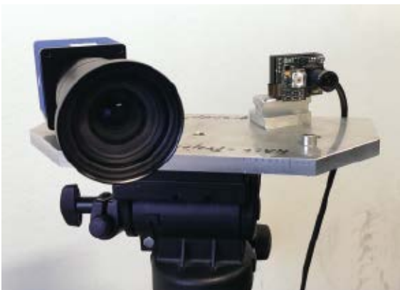
Abb. 3: Gesamtsystem, bestehend aus 3D-Kamera und einer simultan eingesetzten Industriekamera
