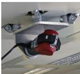
Radian Lasertracker in Deckenmontage, eine für Lasertracker eher ungewöhnliche Anbringung. Nicht alle Tracker können in dieser Lage messen.
