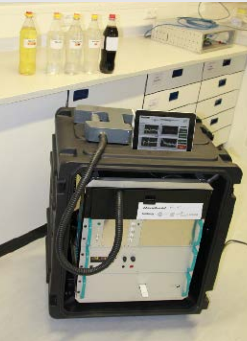
Abb. 4: Mobiles THz-Spektrometer mit Messkopf zur Detektion von gefährlichen Flüssigkeiten
