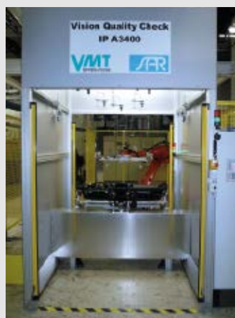
Cockpit-Prüfzelle mit Roboterbestückung
