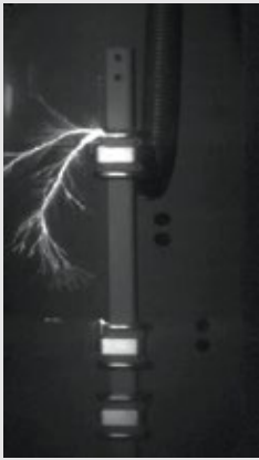
Hochgeschwindigkeitsaufnahme einer Funkenstrecke mit der pco.dimax. Es handelt sich hier um eine Materialprüfung beim Stab eines Wählers. Überraschenderweise erfolgte der Überschlag nicht an der zu erwartenden kürzesten Strecke zwischen den beiden geprüften Elektroden, sondern vom Kopf der Hochspannungselektrode ausgehend im Öl.
