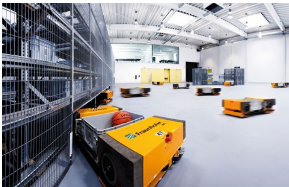
Schwarm Fahrerloser Transportfahrzeuge mit 3D-Kamerasystemen und Laserscannern zur Kollisionsvermeidung
