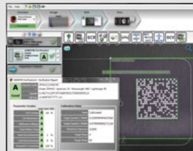
Ein Data Matrix 2D-Barcode ist durch Microscans AutoVision Machine Vision Software nach den AIM DPM Qualitätsstandards verifiziert.
