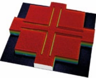
Abb. 2: Wafer-Details genau und schnell ermittelt: mit dem Messsystem können Mikrostrukturen dreidimensional dargestellt und vermessen werden.
