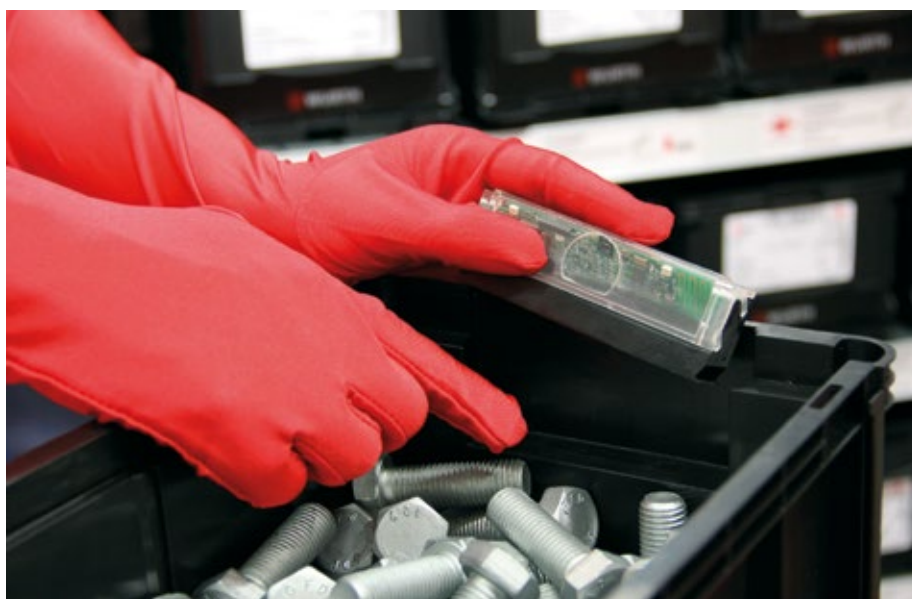
Intelligenter Kanban-Behälter iBin des Unternehmens Würth Industrie Service mit einer eingebauten Füllstanddetektion
