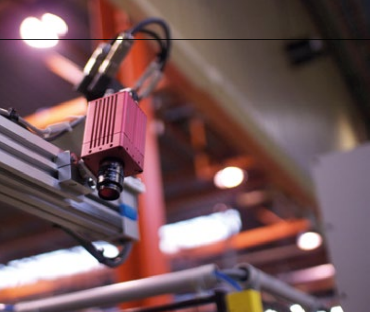
Die Triangulierungskamera erfasst die Bildpunkte der Laserlinie.
