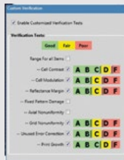
Bewertungs-Parameter für die Verifizierung werden in dem AutoVision Tool „Symbolqualität“ für die Barcodeklassifizierung in der internen Prozesskontrolle eingestellt.
