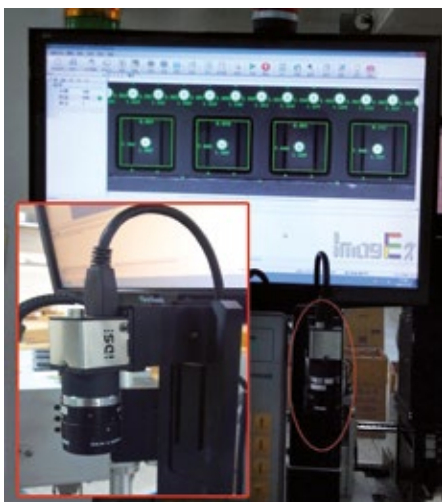
Carrier Tape-Prüfung mit USB 3.0 Industriekamera
