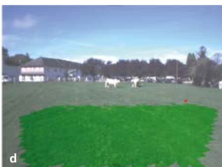
Abb. 3: Klassifikationsergebnisse für zwei Fallbeispiele: (a, c) Fernbereich-Klassifikation mittels Daten der Flea3. (b, d) Die Kurzbereich-Klassifikation nutzt Daten der Bumblebee XB3 Stereokamera.
