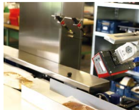
Abb. 3: Barcodeleser der Baureihe BCL 300 sind zum Detektieren ideal geeignet, wenn ein Produktmix zu detektieren wird.
