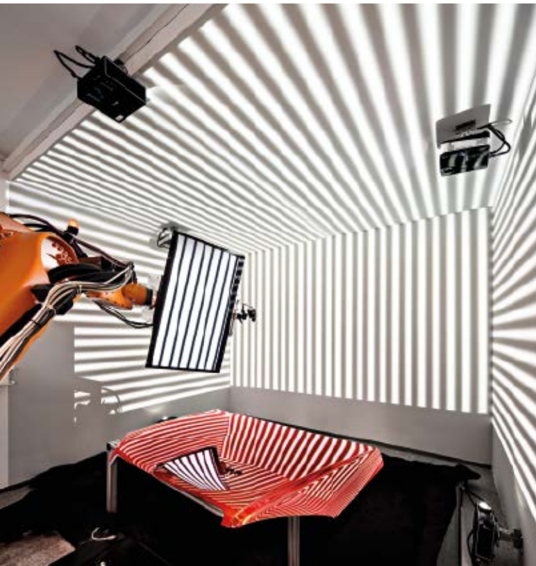
Abb. 1: Deflektometrische Inspektion eines Karosserieteils.
