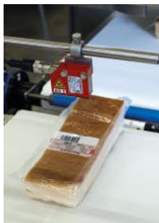
Abb. 2: Barcodeleser BCL 8 von Leuze electronic prüfen den Barcode auf Nahrungsmittelverpackungen.
