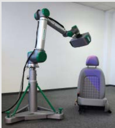
Die Vorderseite des Autositzes, inklusive der Seitenwangen und der Kunststoffblende, wird von dem neuen Leichtroboter RoboScanner von Descam 3D Technologies in nur 5 Minuten eingescannt.
