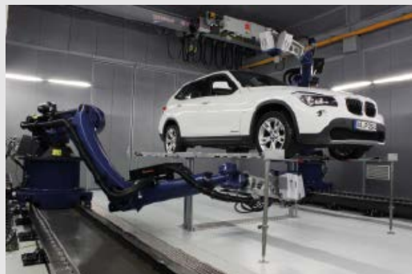
Schwingungsmessung an einer Fahrzeugkarosserie mit 1.094 Messpunkten
