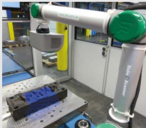
Mit dem Script für dieses Kurbelwellengesenk können bis zu 20 unterschiedliche Gesenke vermessen werden.
