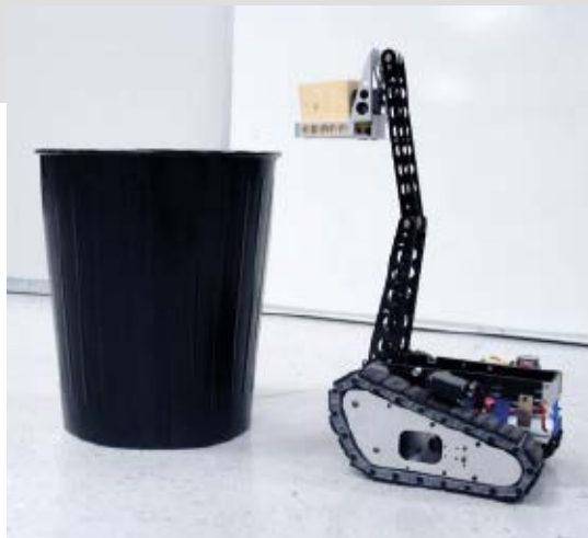
Abb. 1: Ziel war, das Fahrzeug sollte unbekannte Hindernisse überwinden, möglichst viele Musterblöcke aufnehmen und diese in einen Sammelbehälter mit hohem Rand ablegen können. Das ist dem Team „Teamwork Extrem“ von Teledyne gelungen!
