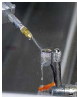
Bei zusätzlichen Tests im hauseigenen Ifm-Labor durchlaufen die Sensoren Extrem-Temperaturwechselbäder. So garantieren sie eine dauerhaft zuverlässige Funktion auch unter schwierigsten Umgebungsbedingungen.
