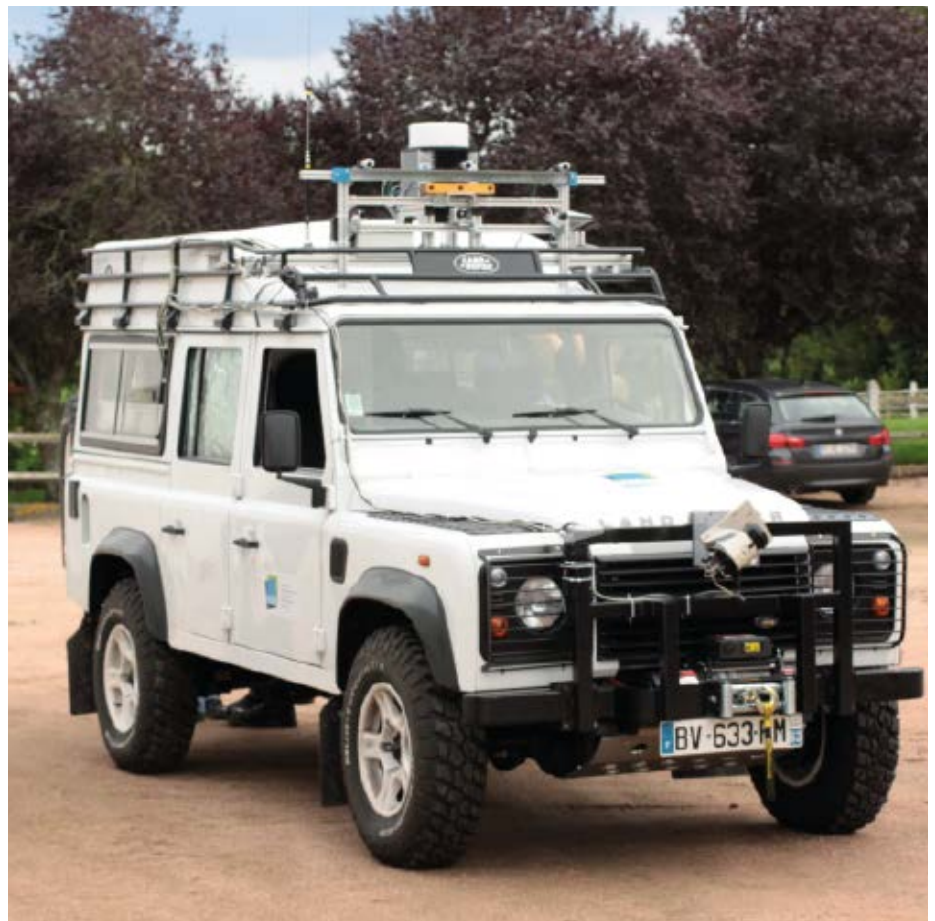
Abb. 2: Auf dem Dach eines Off-Road-Fahrzeugs montierte Stereo-Kamera. Das Fahrzeug wurde vom QUAD-AV-Partner IRSTEA für Feldversuche im Oktober 2012 zur Verfügung gestellt.
