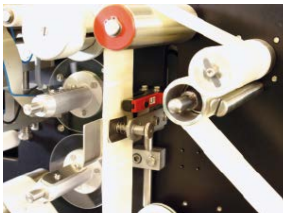
Abb. 1: GS 61 von Leuze electronic ist die nach eigenen Aussagen weltweit kleinste optische Gabellichtschranke in Industriequalität und passt mit ihrem Slimline-Design leicht in die Druckergehäuse der PAW 2000.
