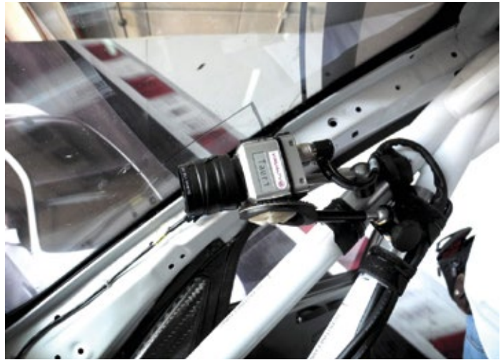
Robuste Kameras, wie das kompakte Full-HD-System Tauri, müssen viel aushalten. Sie dokumentieren Motorsportrennen und donnern in Le Mans 24 Stunden mit bis zu 340 km/h über den Asphalt, in Bahrein durch heiße Wüsten und bei der Rally of New Zealand über wilde Schotterpisten.
