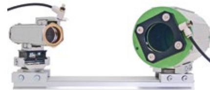
Abb. 2: Robuste Laser-Triangulationsanordnung bestehend aus Laser-Schutzgehäuse, Schwalbenschwanzprofil und Klemmen sowie Kameragehäuse. Beide Gehäuse sind mit Staubschutzvorrichtung für die Frontscheibe ausgestattet – regulierbare Luftdüse bzw. Windvorhang.
