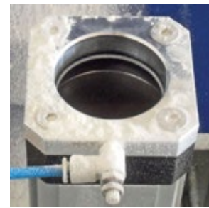
Abb. 6: Der Windvorhang im Test mit nach oben gerichtetem Salamandergehäuse. Bestäubung mit Weizenmehl bei 50 Litern pro Minute Volumenstrom und 5 bar Druck. Nicht klebende Stäube lassen sich auch vor der Bildaufnahme wegblasen. Durch Erzeugung eines Luftwirbels nach dem Tornadoprinzip wird die benötigte Luftmenge minimiert.
