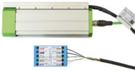
Abb. 10: Schutzgehäuse mit geregelter Heizplatte und Heizungsregler – hier wird permanent die Temperatur der Heizplatte über einen PT100 Fühler gemessen und die aktuell benötigte Heizleistung zur Verfügung gestellt.
