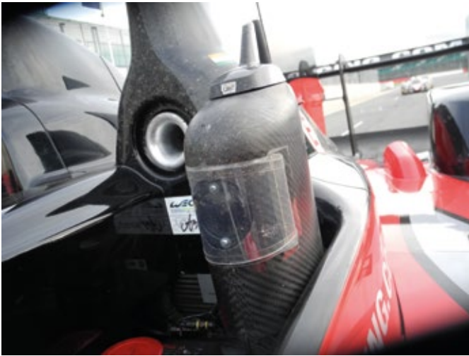
Schock- und vibrationsfeste Onboard-Kameras Tauri-HD von Kappa optronics filmen das Rennen aus der Perspektive des Piloten.
