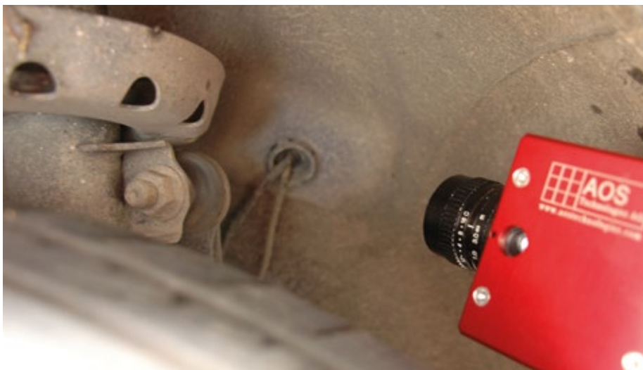
Beim Fahrwerk-Federungstest sitzt die Promon 501 Kamera von AOS Technologies direkt im Radkasten des Fahrzeugs. Über eine Verbindung werden die Bilddaten mit bis zu 200 Bildern/s direkt an einen handelsüblichen, jedoch vibrationsfesten PC gesendet und aufgezeichnet. Eine Fahrt kann 20 Minuten oder länger dauern.
