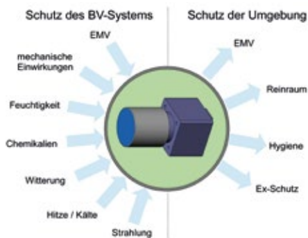
Abb. 1: Es gibt vielfältige Einwirkungen der Umwelt, vor denen ein Bildverarbeitungssystem geschützt werden muss. Doch in manchen Anwendungen ist es umgekehrt und die Umgebung muss vor schädlichen Einwirkungen durch das Kamerasystem bewahrt werden.
