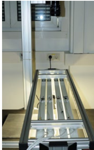
Aufnahmeeinheit mit Zeilenkamera, Beleuchtungseinheit und Ätzscheibe am Förderband
