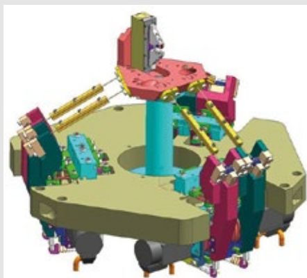
Abb. 4: Hexapod-Roboter von Philips: Oben ist die Plattform mit Greifer dargestellt. Diese wird durch insgesamt sechs Spritten gehalten, die wiederum an einem Gelenk befestigt sind (dunkelgrau). Diese Gelenkarme werden durch Kurvenscheiben bewegt, die auf Motorachsen (grau unterhalb der Basis) befestigt sind.
