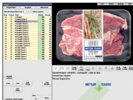
Bildverarbeitungs- und Bildanalyse-Software CIVCore von Mettler-Toledo analysiert automatisiert bis zu 250 Bilder pro Minute.
