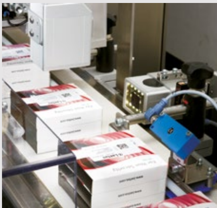
Secure-Track&Trace-System-Lösungen von Laetus lassen sich in vielfältige Produktionsinfrastrukturen integrieren. Hier die sichere Aggregation mit S-TTS.
