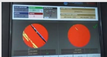
Abb. 3: Die Bedieneroberfläche des Orientators zeigt hier einen Korken, bei dem das System eine der beiden geprüften Seiten als „gut“ bewertet hat.
