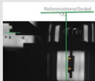
Abb. 5: Aufnahme einer HPH-Lampe aus zwei zueinander senkrecht stehenden Ansichten. Die dicke Linie markiert die aus der Kalibrierung erlernte Lampenachse, von der aus h1 und h2 gemessen werden. Das e-Maß ist der Abstand zwischen Sockelebene und Wendeloberkante.
