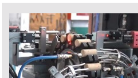
Abb. 1: Die auf dem Kammrad präsentierten Korken werden mit zwei Laserlinien gescannt.
