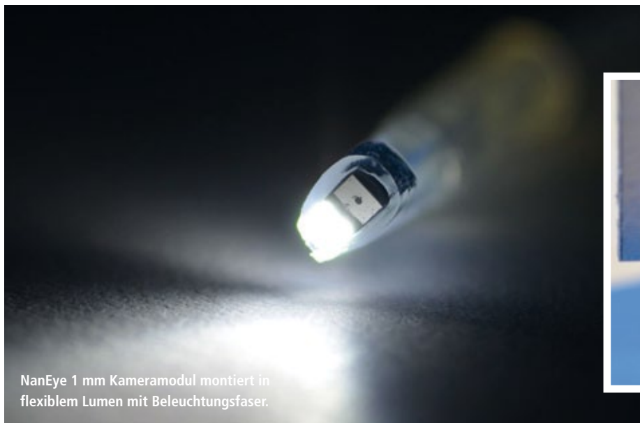
Aufgebautes Einweg Kamera Modul mit LED Beleuchtung. Durchmesser 2,2 mm.
