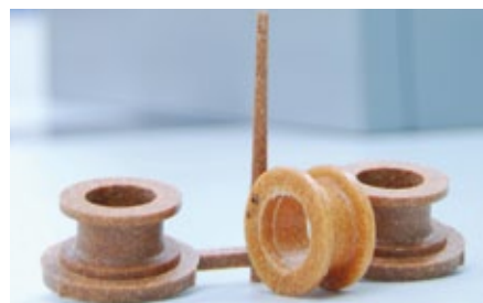
Abb. 2: Geschweißtes Testobjekt aus Holzfaserverbundwerkstoff
