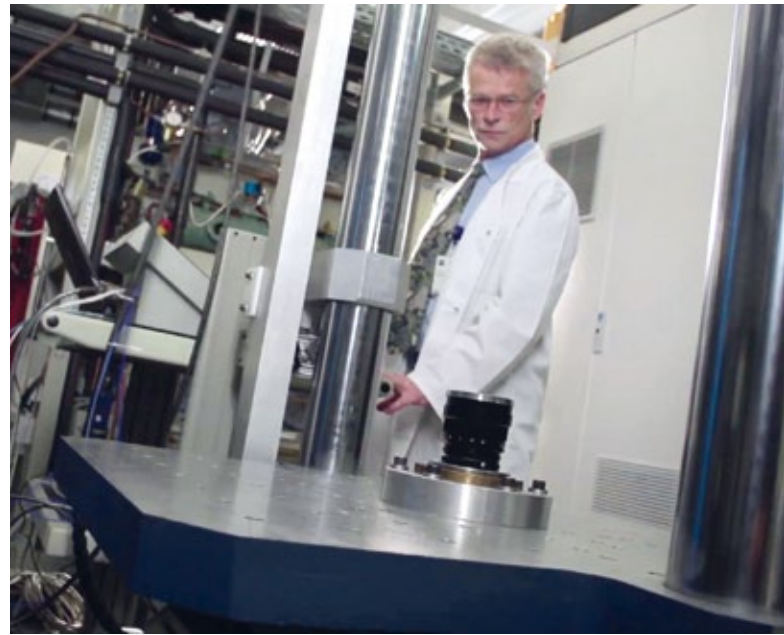
Objektiv wird hartem Schocktest unterzogen.
