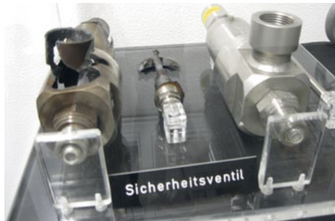
Eine verheerende positive Rückkopplungsschleife während einer Sauerstoff-Druckstoßprüfung zeigt Auswirkungen auf das Ventil, das dabei zerstört wurde.
