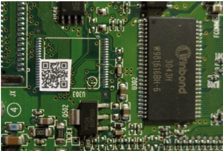
◀ Abb 2: PCB mit 2D-Barcode
