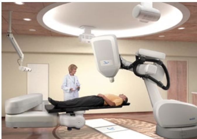
Cyberknife, punktgenaue Bestrahlung von kranken Zellen
