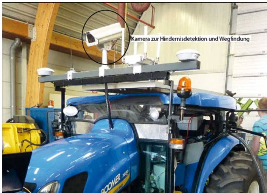
Abb. 3: Am Traktor angebrachte Kamera zur Aufnahme der Bilder, die sowohl zur Detektion der Hindernisse als auch für die 3D-Rekonstruktion verwendet werden.
