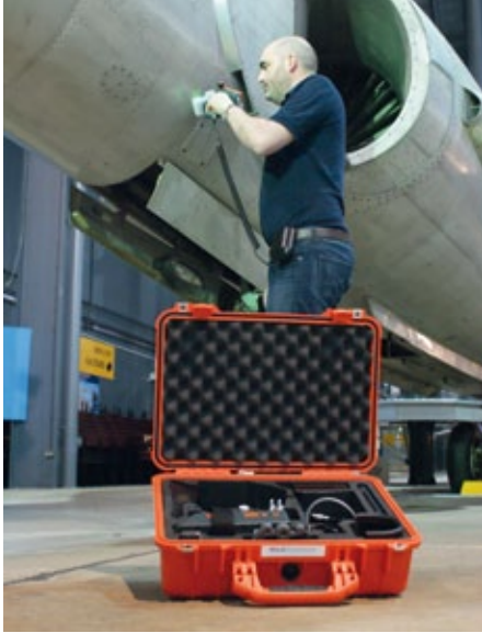
Das Lasermessgerät ist überall einsetzbar, sodass der Prüfling direkt vor Ort analysiert werden kann. (Quelle: Third Dimension, Aimess)
