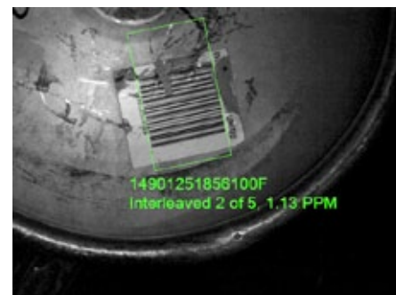
Bildbasierte ID-Lesesysteme können die Codes völlig lageunabhängig lesen. Absolut zuverlässige Bildverarbeitungs-Algorithmen gewährleisten Leseraten jenseits von 99%.
