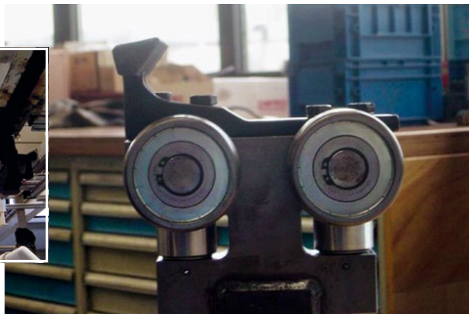
Diese Laufrollen des Fördersystems werden jetzt ► vollautomatisch überwacht. © PSI Technics Ltd.
