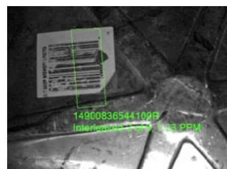
Beschädigte Codes führen beim Laserscanner zu fehlerhaften Ergebnissen. Der bildbasierte Codeleser bewältigt auch derartige Anforderungen mit extremer Lesesicherheit.
