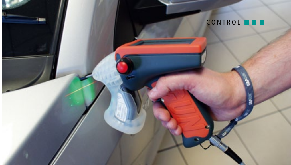
Die GapGun projiziert eine sichtbare Linie auf das Messobjekt. (Quelle: Third Dimension, Aimess)
