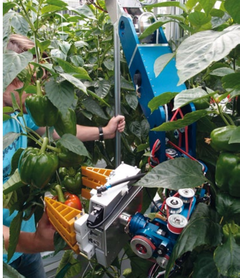
Erster Prototyp des CROPS-Roboterarms und -Greifers bei Tests im Gewächshaus. Der Roboterarm wurde vom Institut für Angewandte Mechanik der TU- München entwickelt, der Greifer kommt von Festo.
