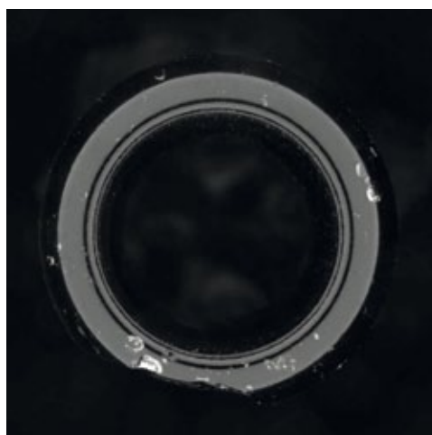
Abb. 1: Prüfbild einer Uni-Normflasche 0,5 Liter – Inspektion auf Verunreinigungen innerhalb der Flasche sowie die Formhaltigkeit Außenkontur (li.); Überprüfung der Dichtfläche (re.). Foto: Vision & Control
