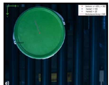
Abb. 2: a) Zentrum des Eimers nach Anwendung der Hough-Transformation, b) Position der Henkelbefestigung, c) Winkelposition der Befestigung, d) Definition der Bereiche für die Pixelzählung, e) Ausrichtung und Position des Eimers
