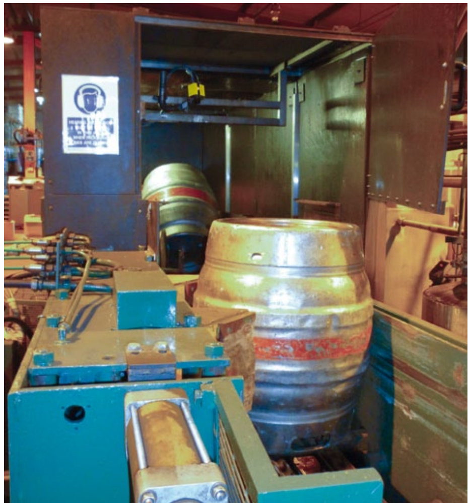
Der kleine gegenüber Umwelteinflüssen abgekapselte DataMan 500 ermöglicht eine flexible und sichere Arbeitsweise innerhalb des Prozesses der Fassabfüllung.
