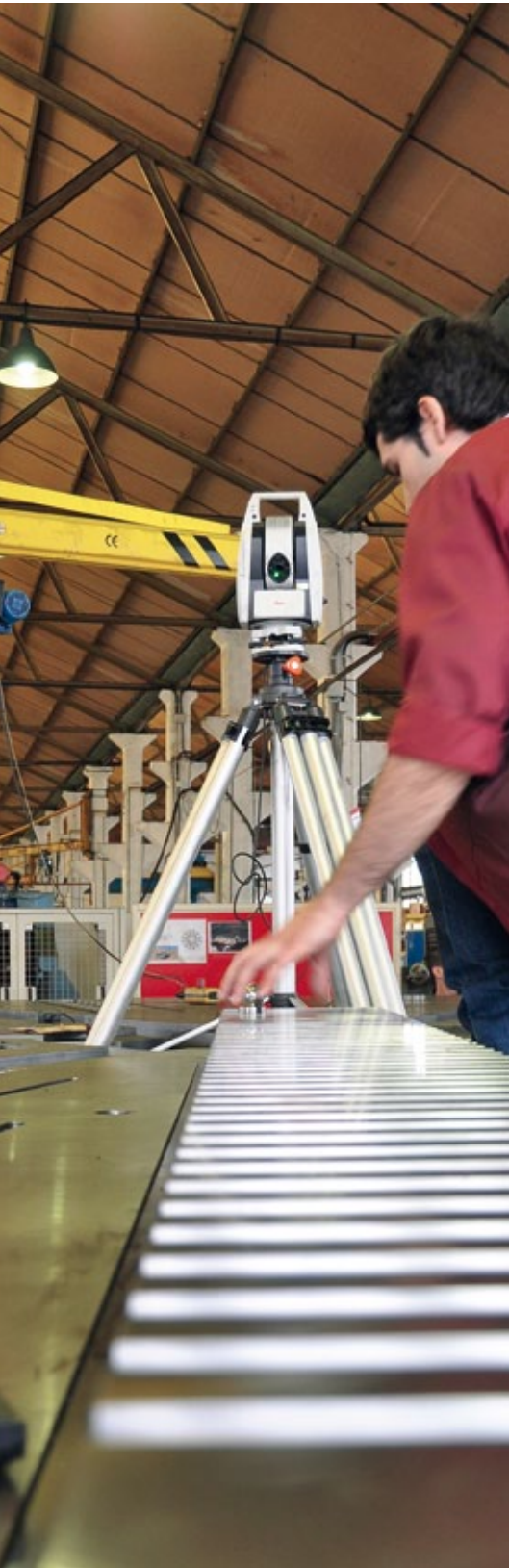
Eine Person reicht – Betrieb des Laser Trackers mit Fernbedienung und PowerLock.
