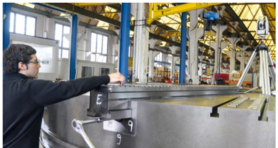
Präzise Messdaten sind die Grundlage für die erfolgreiche Herstellung des 7m-Spannfutters bei Talleres de Guernica.
