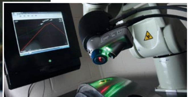
Das Lasermessgerät kann auch automatisiert durch Roboter geführt werden.
