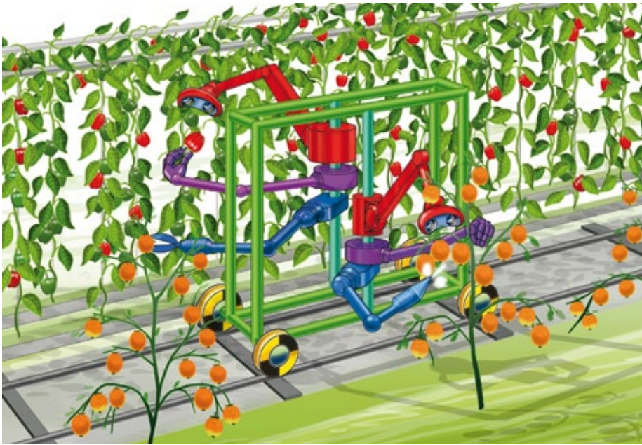
Schematische Darstellung: Die modulare Trägerplattform (grün) mit Manipulatoren (blau und violett) und Sensoren (rot) zur robotisierten Ernte von Früchten.
