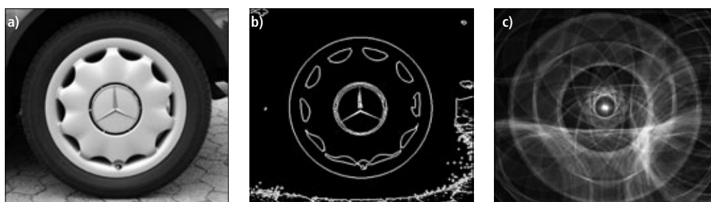
Abb. 3: a) Quellbild; b) Konturen sind herausgearbeitet und verdünnt; c) Kontrastverstärktes Akkumulator-Bild nach Anwendung der Hough-Transformation auf das verdünnte Konturbild
