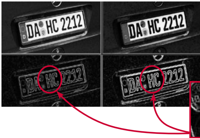
Abb. 2: Graustufenbild, dilatiertes Graustufenbild (oben) und Ergebnis der Differenzbildung (links unten); zum Vergleich rechts unten Ergebnis einer Sobel-Filterung mit Detailausschnitt aus den Kantenbildern
