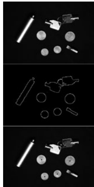
Abb. 4: Graustufenbild (oben), Kantenbild (Mitte) und Ergebnis der Hough-Transformation für Kreise (unten); eingeblendet in das Originalbild sind als Punkte die Mittelpunkte der gefundenen Kreise. Auch der teilweise verdeckte Schlüsselring wird gefunden.
