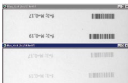
Abb. 5: Ein blau gedruckter Barcode (oben) und ein rot gedruckter Barcode (unten), beleuchtet mit einer Glühlampe und aufgenommen mit einer Graustufenkamera
