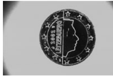
Abb. 4: Aufnahme einer Münze mit ringförmiger Beleuchtung zur Hervorhebung der Kanten
