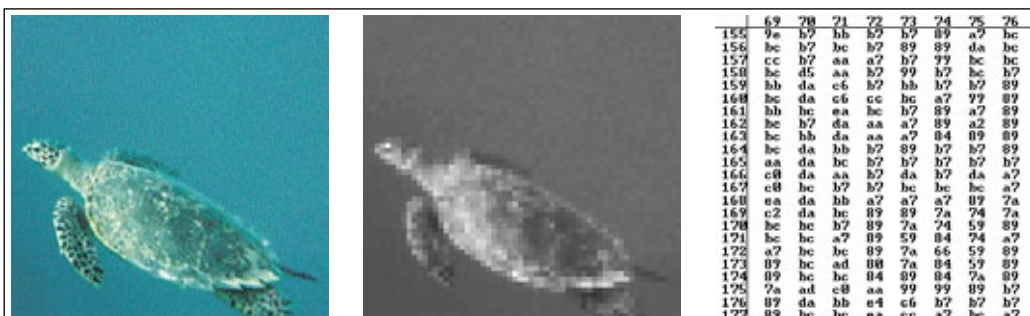
Abb. 3: Eine reale Szene wird optisch auf den Bildaufnehmer abgebildet (links). Durch die räumliche Abtastung und die Digitalisierung der Helligkeitsverteilung wird die Information drastisch reduziert (Mitte) und in einem Bilddatenfile geordnet abgelegt (rechts).
