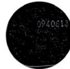
Abb. 4: Ergebnis des Bildverarbeitungsalgorithmus einer Kennzeichnung auf einer ca. 1.000 °C heißen Oberfläche.
