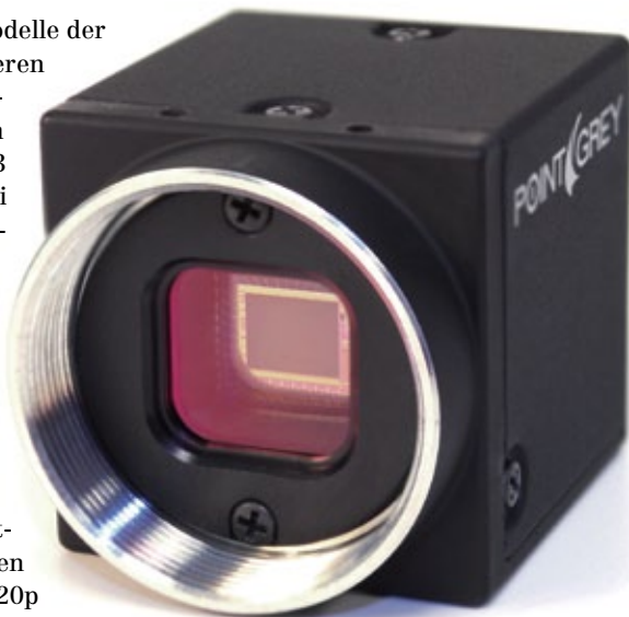
Flea3 CMOS-Kamera mit echten Global Shutter.
