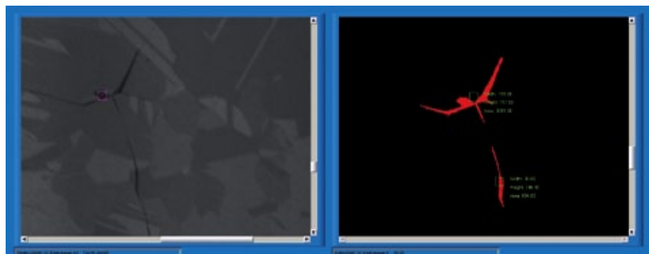
Die in der automatisierten Solarzellenfertigung möglichen Mikrorisse an den Wafern werden mit Nahinfrarotlicht sichtbar gemacht.
