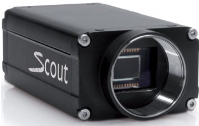
Im Oberflächen-Inspektionssystem kommen Basler-Scout-Kameras mit Gigabit-Ethernet-Schnittstelle zum Einsatz.
