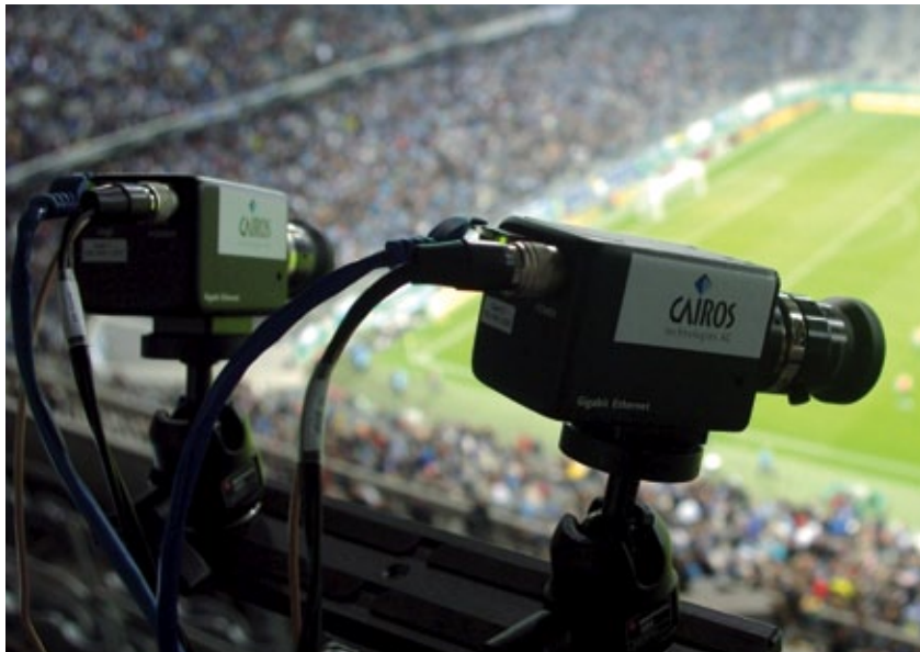
Eine Kamera pro Spielfeldhälfte nimmt die Bewegungen aller Akteure auf. Während der Testphase des Systems wurden die Kameras noch ohne Schutzgehäuse betrieben.
