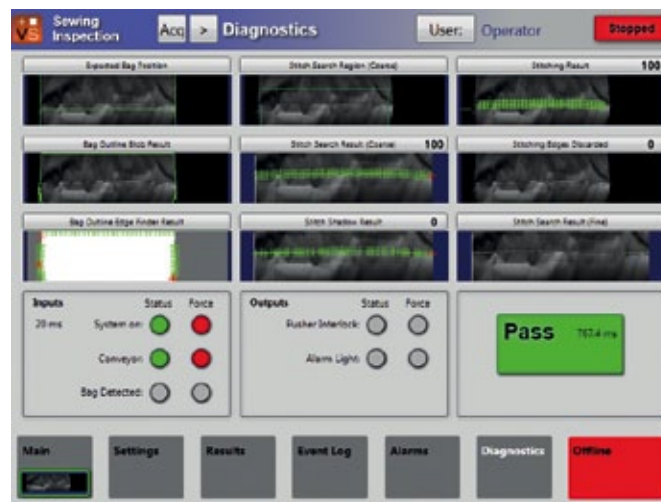
Eine von VisionServer Framework generierte Benutzeroberfläche zur Inspektion der Nähte von Zuckertüten.
