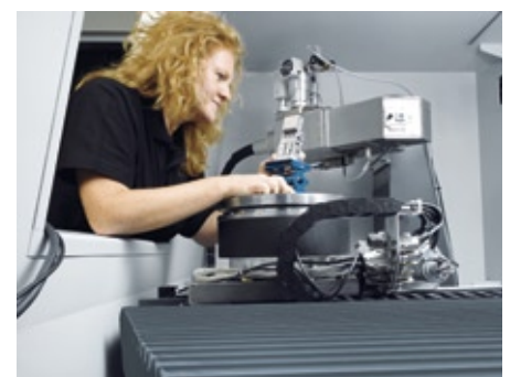
Ausrichtung eines Bauteils für die CT-Untersuchung
