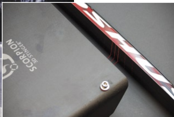
Abb. 1: Scorpion 3D Stinger-Kamera projiziert drei Laserlinien auf die Lauffläche eines Madshus Langlaufski.
