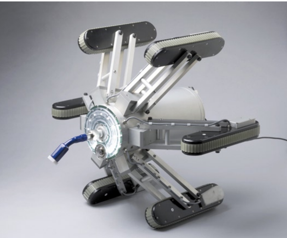
Der Jetty-Roboter in der Grundkonfiguration für ringförmige Rohrleitungen (350–700 mm)
