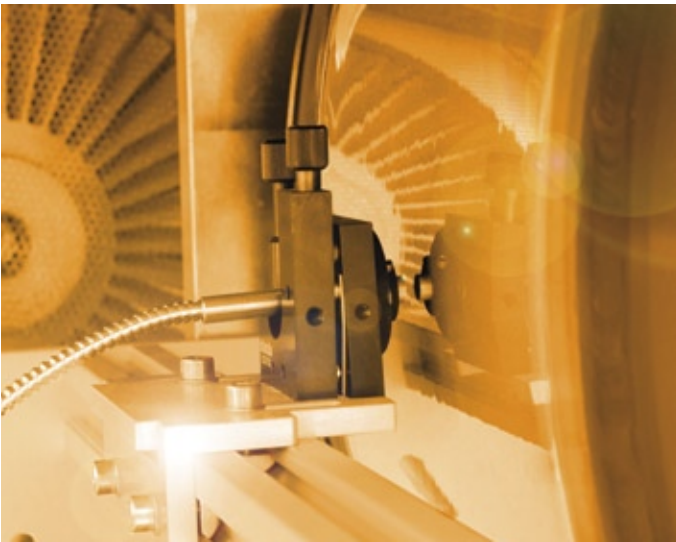
Messkopf des SolR Messsystems in einer TCO-Sputteranlage, im Hintergrund ist die Turbomolekularpumpe zu erkennen
