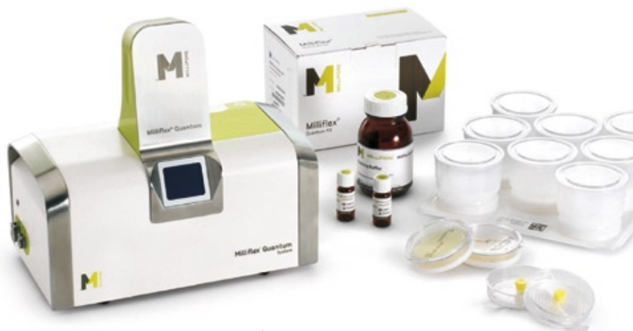
Mit dem System Milliflex Quantum von Millipore lässt sich die mikrobiologische Belastung von Flüssigkeiten sicher und erheblich schneller als bisher messen.
