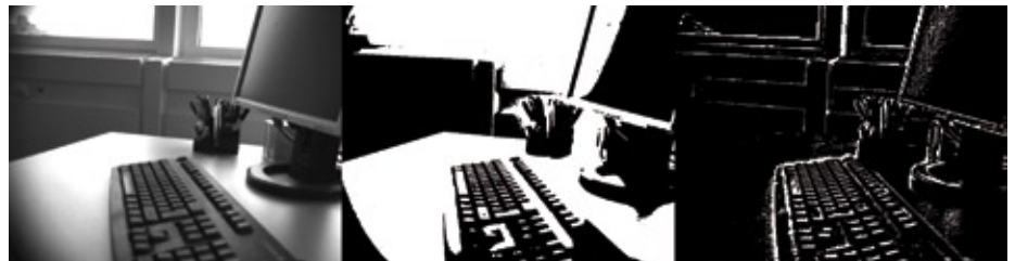
Originalbild (links), Binarisierung über globalen Schwellwert (Mitte) und adaptive Binarisierung mit aktiviertem Rauschfilter und zweifacher Open-Close Morphologie (rechts)
