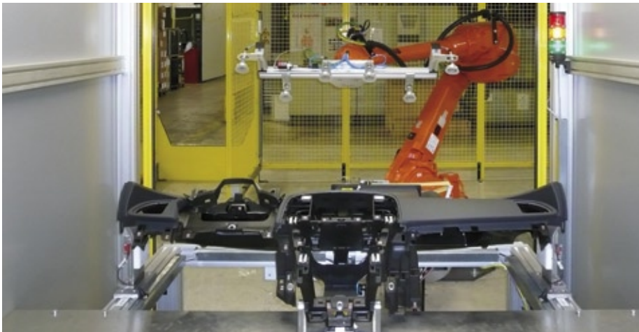
Die vollautomatische Prüfzelle von VMT kontrolliert PKW-Cockpits auf 50 verschiedene Merkmale.
