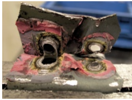
Abb. 7: Ergebnis nach dem Aufmeiseln, der linke Schweißpunkt lässt sich nicht sicher vermessen.
