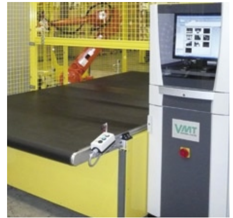
Erweist sich das Cockpit als fehlerhaft, entnimmt der Roboter das Bauteil aus der Prüfposition und legt es auf dem Nacharbeitsband ab.
