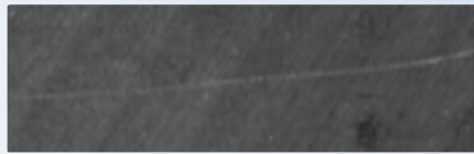
Je nach Beleuchtung sind Kratzer nur in bestimmten Richtungen sichtbar.
