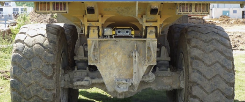
Das Blaxtair-System überwacht den rückwärtigen Bereich eines Muldenkippers.
