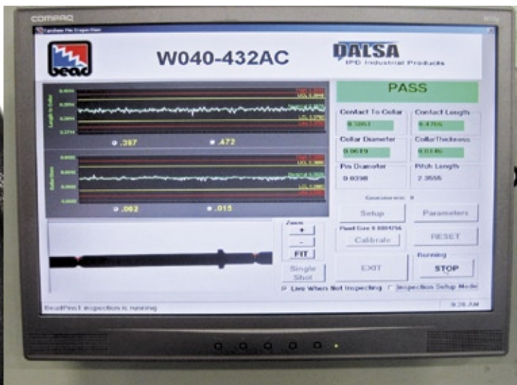
Das Inspektionssystem kontrolliert jeden einzelnen Schaltstift, der das Unternehmen Bead Industries verlässt.
