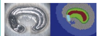
Abb. 6 :Laserschweißnaht, links Realbild, rechts Thermogramm
