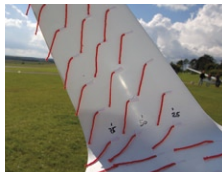
Etwa 50 rote Wollfäden folgen dem Verlauf der Luftströmung und weisen auf unerwünschte Verwirbelungen hin.
