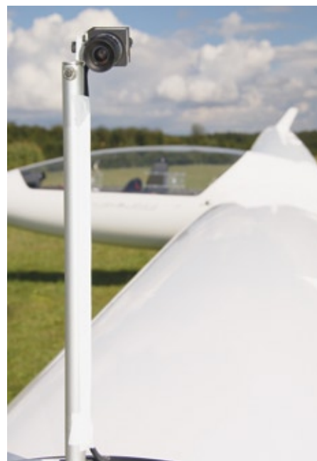
Die USB-Kamera UI-1240SE mit 1,3-Megapixel-Sensor hält jede Bewegung der Wollfäden im Video fest.
