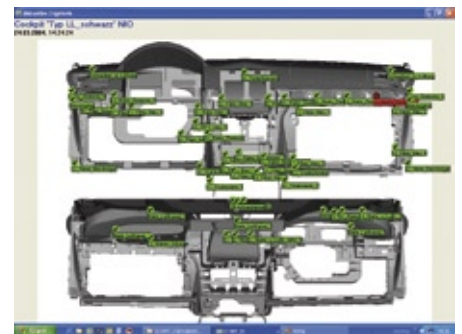
Die Benutzer-Oberfläche des Bildverarbeitungssystems: Der Nachbearbeiter erkennt auf einen Blick, wo der Fehler bei dem geprüften Cockpit zu finden ist.
