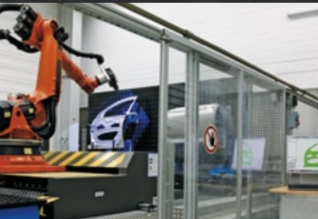
Abb. 1: In der Roboter-Messzelle werden Blechbauteile vom Schließblech bis zur kompletten Seitenwand zeitsparend kontrolliert.
