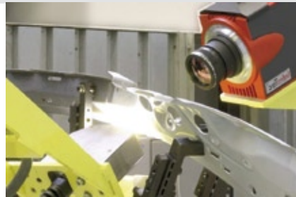
Abb. 8: Prinzip der Transmissions-Impuls-Thermographie an Schweißpunkten (oben) und Umsetzung am Bauteil (unten).
