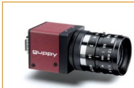
Zwei Guppy-Digitalkameras verbaute das Studenten-Team bei ihrem Unterwasser-Roboter: Die eine schaut nach vorne, und erkennt mögliche Hindernisse, die andere detektiert alles, was sich unter dem Roboter befindet, wodurch Gegenstände geborgen werden können.
